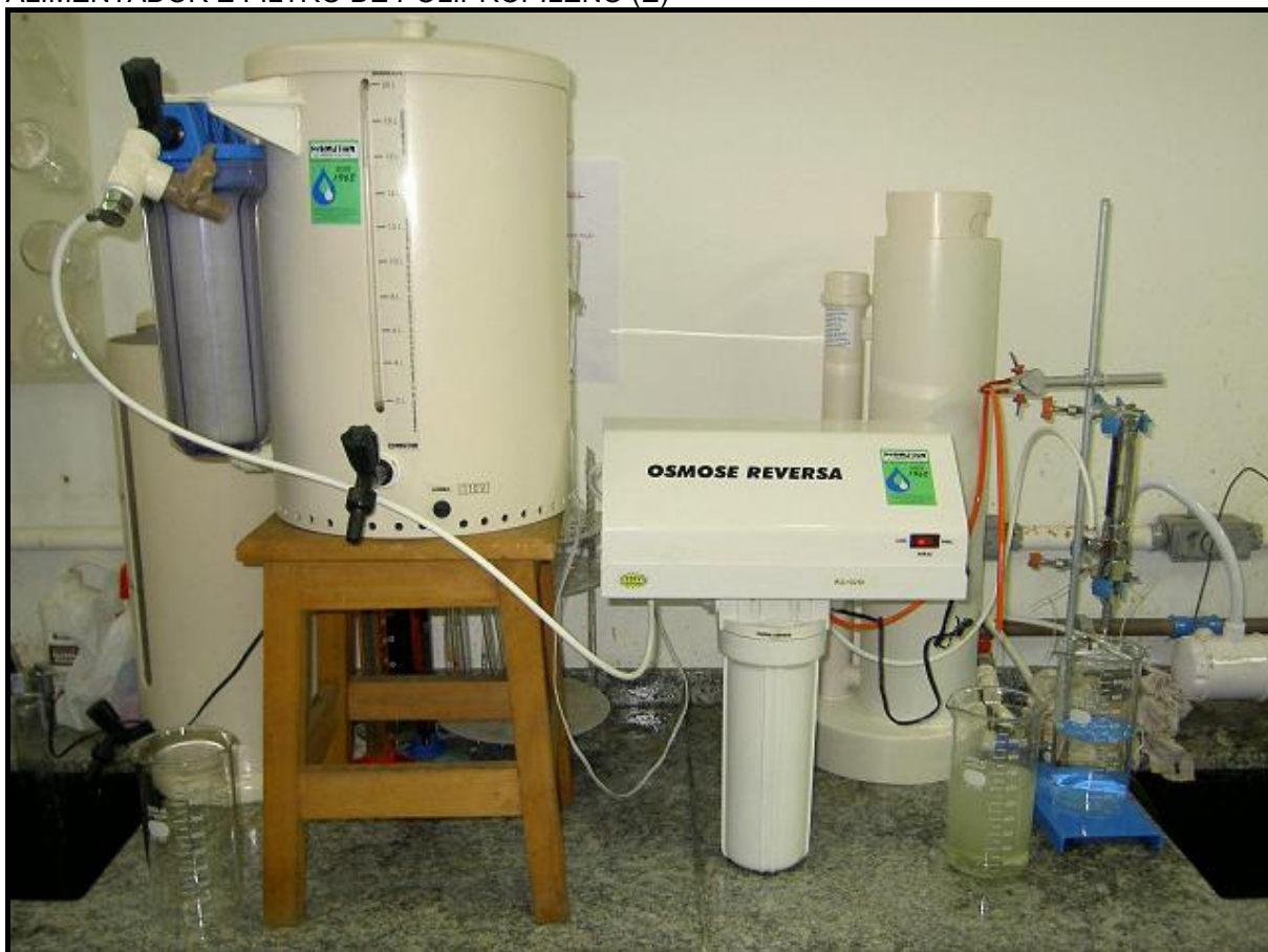
FIGURA 3.9 – UNIDADE DE BANCADA DE OSMOSE REVERSA (D) PRECEDIDA POR TANQUE ALIMENTADOR E FILTRO DE POLIPROPILENO (E)
