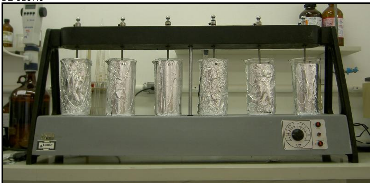
FIGURA 3.8 – APARELHO TIPO JAR-TEST USADO DURANTE OS ENSAIOS DE COM DIÓXIDO DE CLORO
