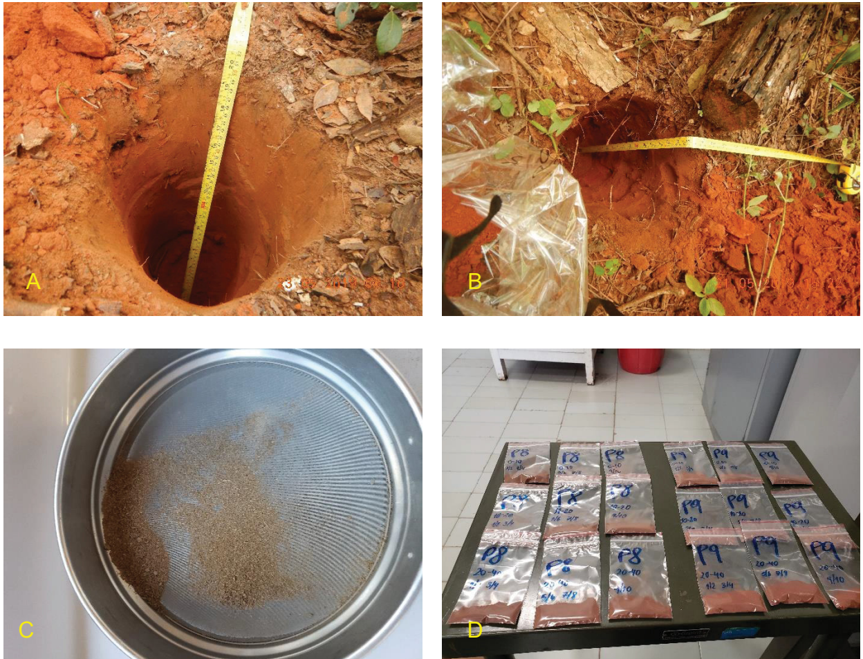
FIGURA 14 – COLETA E TRIAGEM DE AMOSTRAS DE SOLO; A, B – CAVIDADE PARA COLETA DE SOLO; C – PENEIRA DE 2 MM; D – AMOSTRAS FRACIONADAS PARA ANÁLISE DE CARBONO E NITROGÊNIO.
