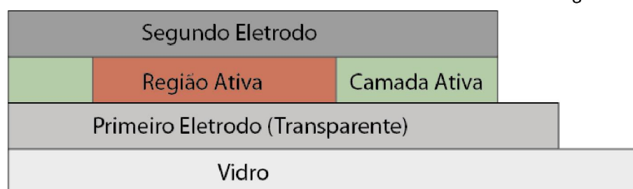
FIGURA 16 – Estrutura básica de um Célula Fotovoltaica Orgânica.
