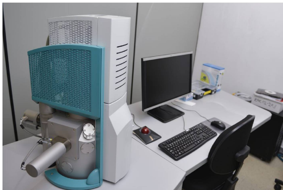
FIGURA 27 – Microscópio Eletrônico de Varredura TESCAN VEGA3 LMU
