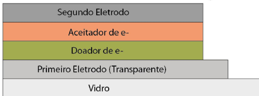
FIGURA 18 – Estrutura básica de uma Célula Fotovoltaica Orgânica de Bicamadas
