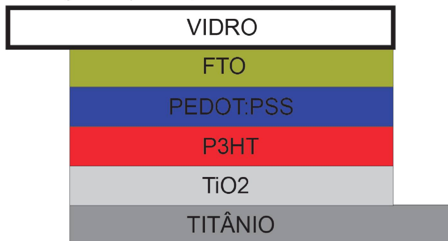
FIGURA 24 – Diagrama esquemático, em corte transversal, da estrutura a ser projetada.
