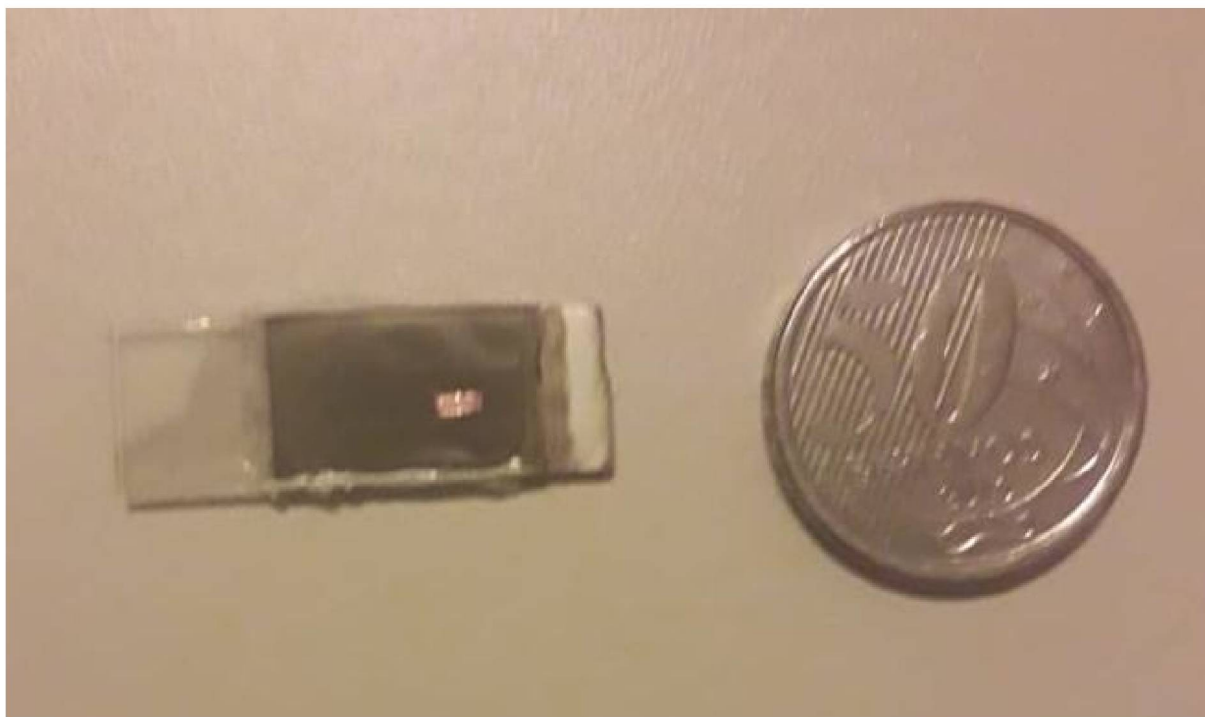
FIGURA 47 – Célula solar obtida ao final do processo, imagem com uma moeda para efeito de comparação
