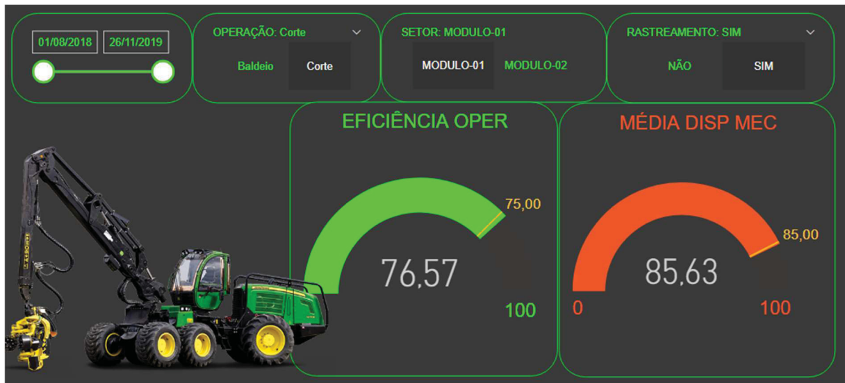
Figura 9: Dashboard equipamento com telemetria.
