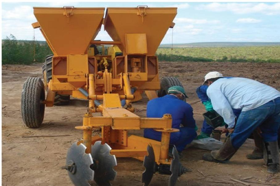
Figura 4 – Retirada do adubo para verificar a quantidade.
