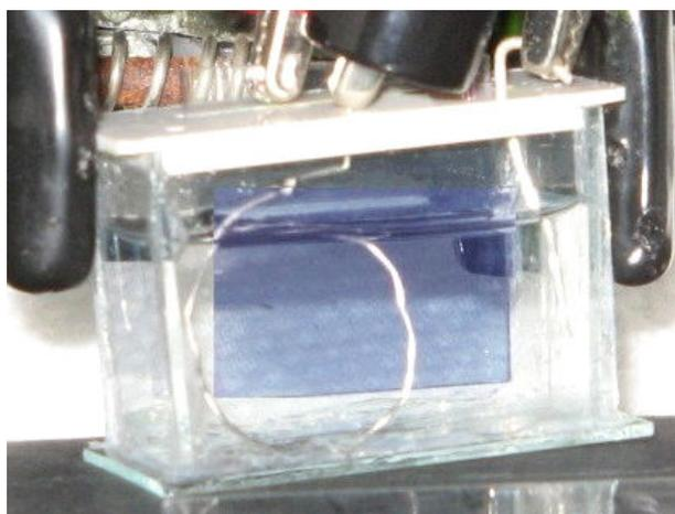
Figura 2 – Célula eletroquímica utilizada nos experimentos espectroeletroquímicos.
