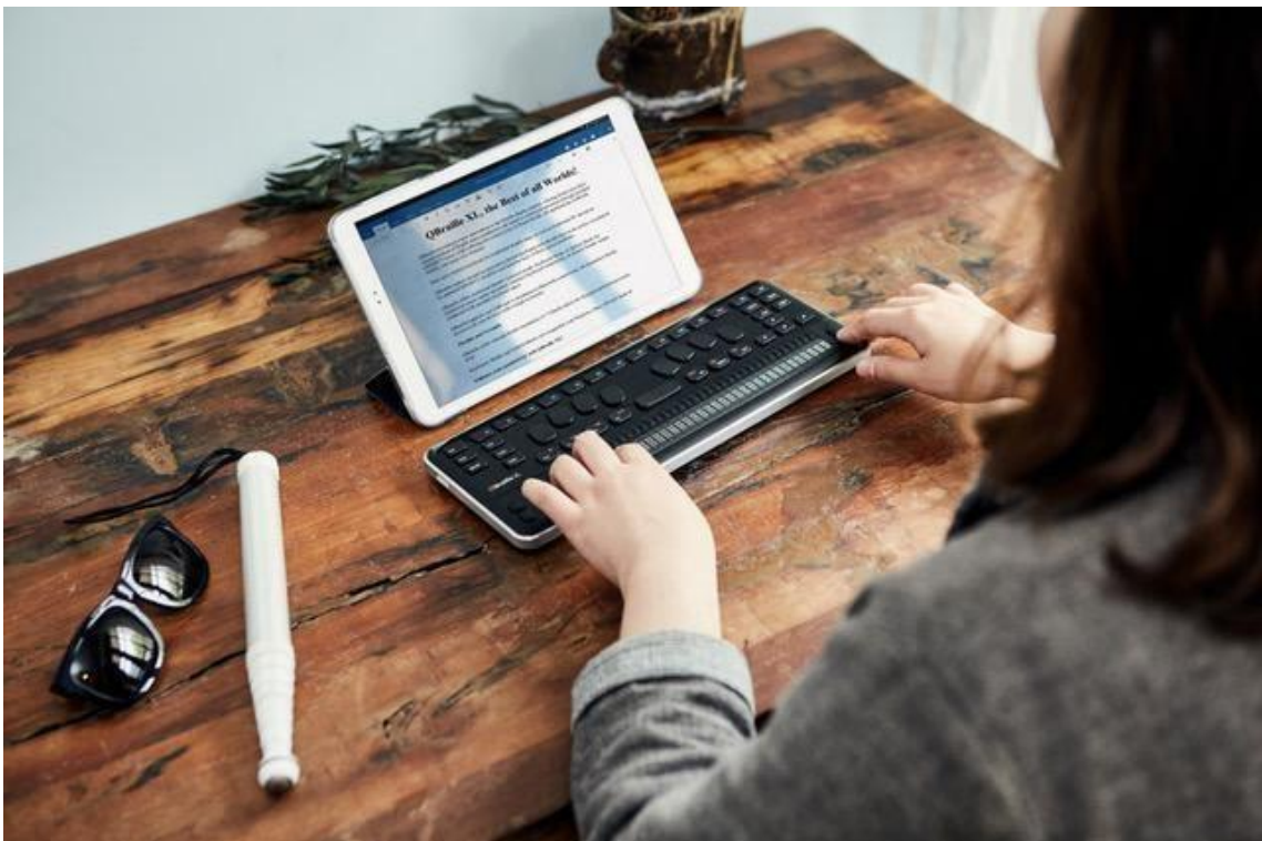
FIGURA 17 – LINHA BRAILLE MODELO QBRAILLE XL.
