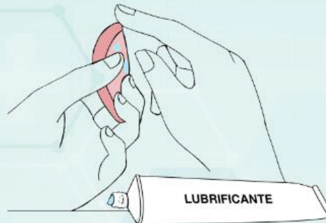
Figura 15 - Aplicação de lubrificante
