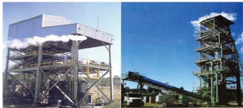
Figura 3 - RETORTA DE CARBONIZAÇÃO CONTÍNUA DE MADEIRA
