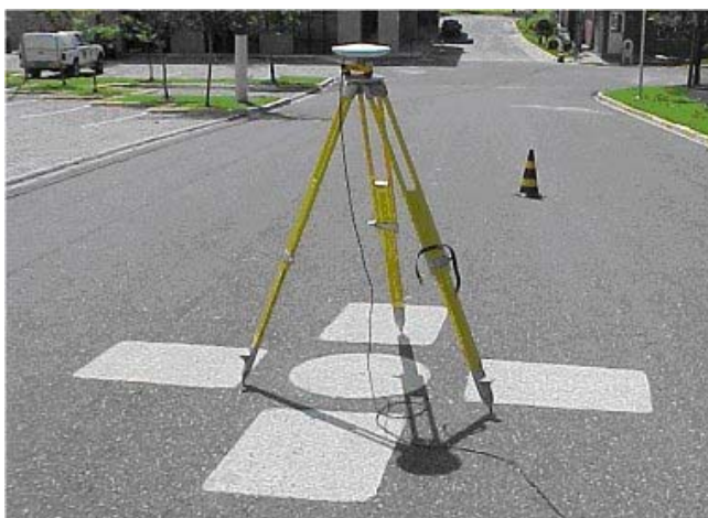
FIGURA 3.3 - PONTO PRÉ-SINALIZADO EM FORMA DE CÍRCULO
