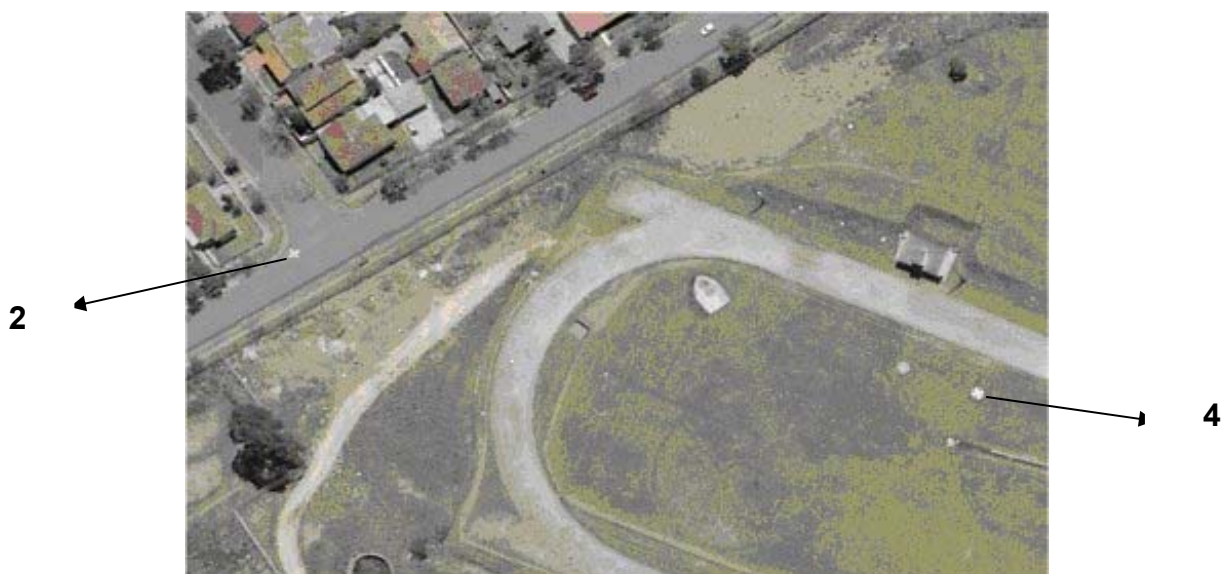
FIGURA 3.7 - PONTOS PRÉ-SINALIZADOS 2 E 4
