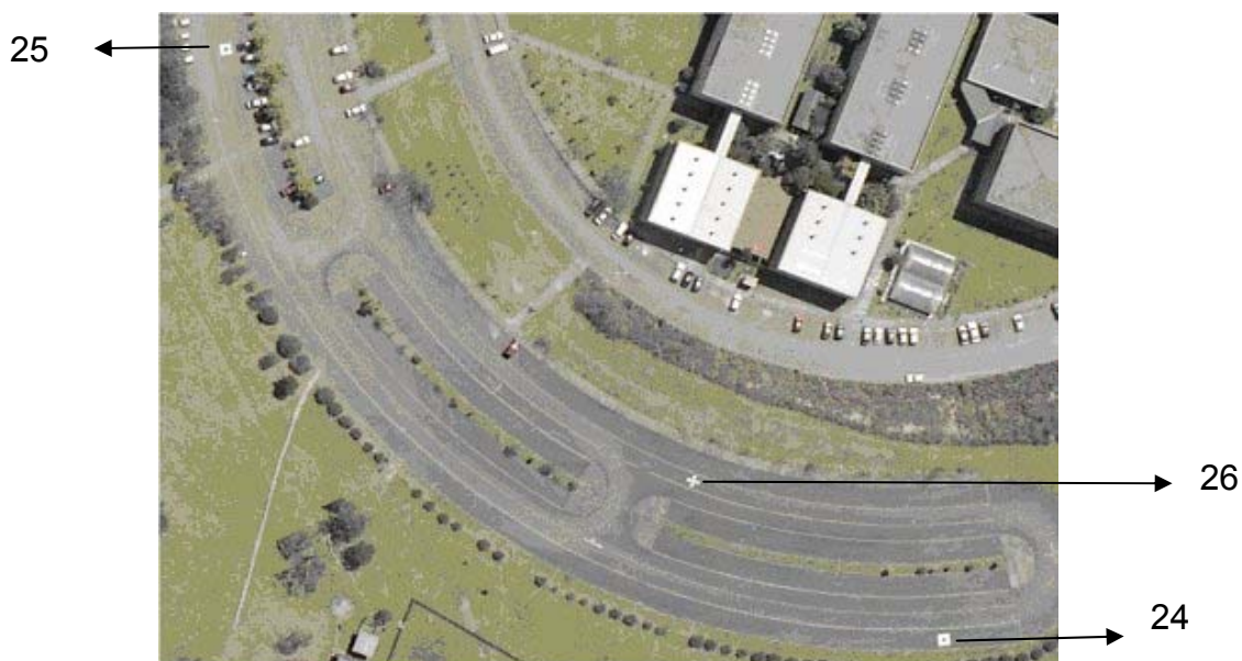
FIGURA 3.18 - PONTOS PRÉ-SINALIZADOS 24,25 E 26
