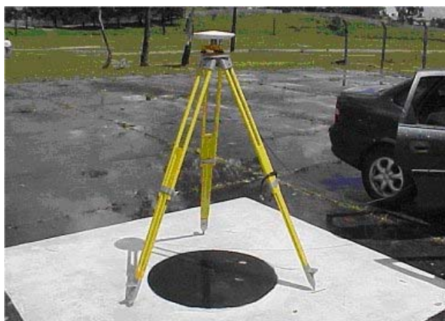
FIGURA 3.3 - PONTO PRÉ-SINALIZADO EM FORMA DE CÍRCULO
