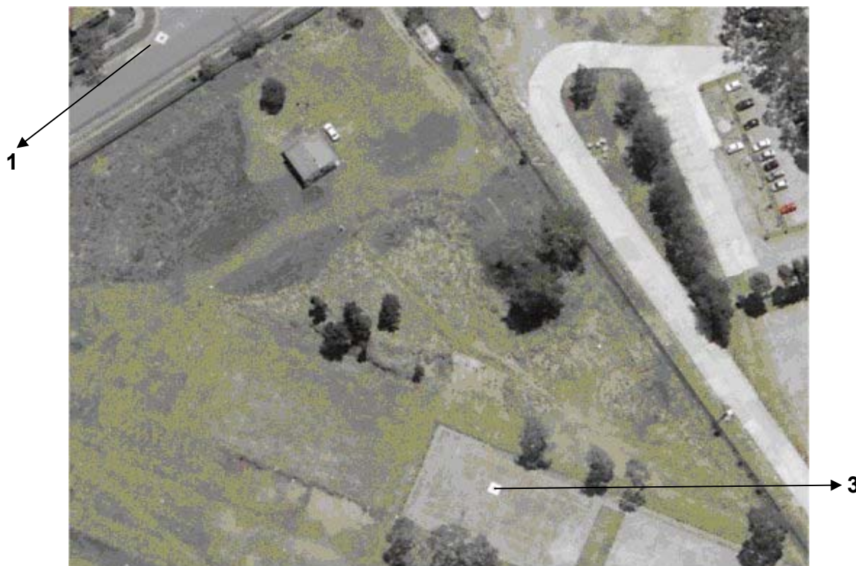
FIGURA 3.6 – PONTOS PRÉ-SINALIZADOS 1 E 3
