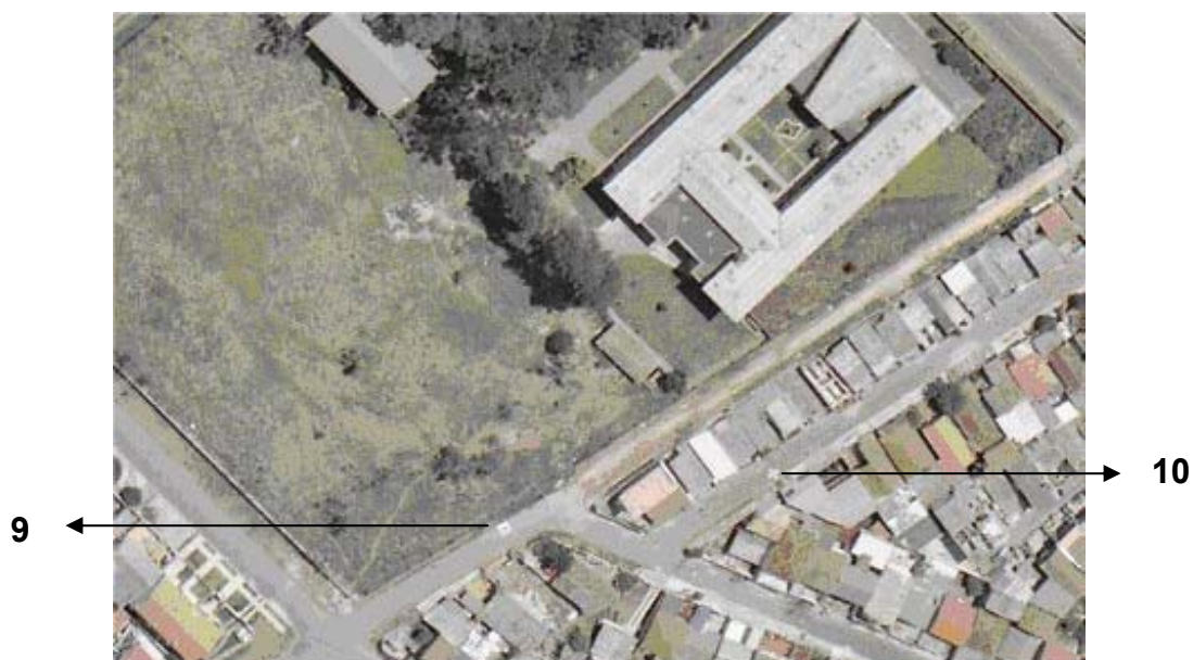
FIGURA 3.11 - PONTOS PRÉ-SINALIZADOS 9 E 10
