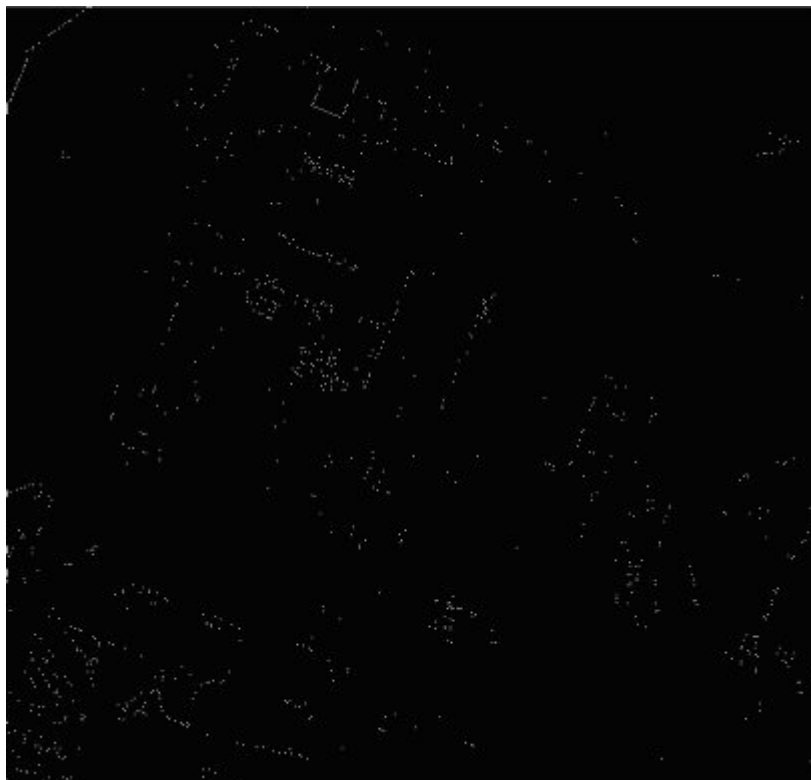
FIGURA 4.19 – PARTE DE AEROFOTO ERODIDA NO NÍVEL 2
