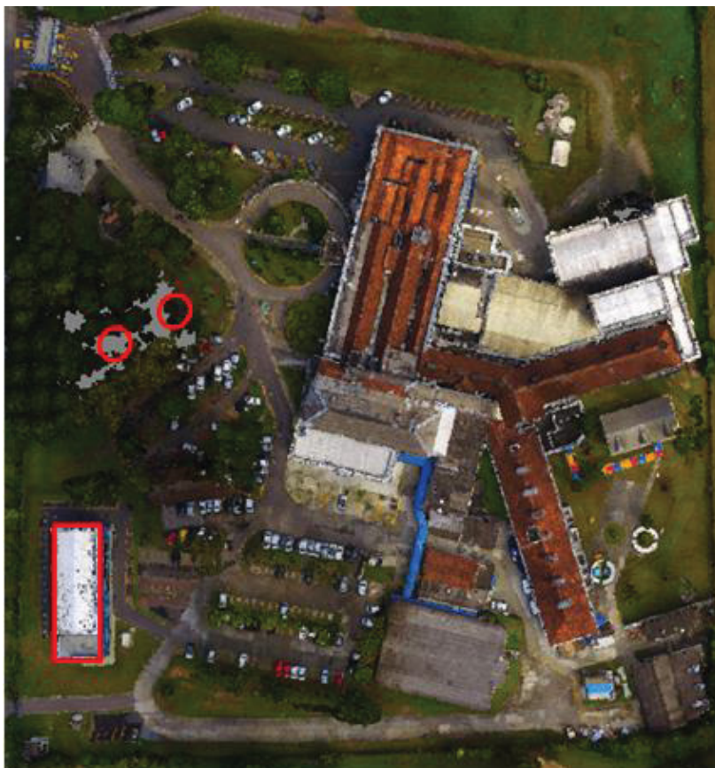
FIGURA 19 – Amostra de cenário para inferência de qualidade visual da nuvem densa de pontos no recobrimento 100 m Inclinado (RLO 80% e RLA 75%).
