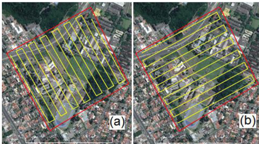
FIGURA 10 - Voo a 100 m, câmera na posição inclinada. Ambos (a) e (b) com sobreposição longitudinal de 80% e Lateral de 75%.
