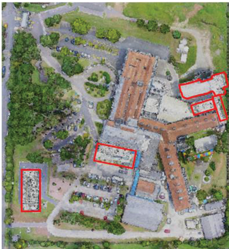
FIGURA 27 – Amostra de cenário para inferência de qualidade visual da nuvem densa de pontos no recobrimento composto a 100 m e 200 m, fotos verticais, (RLO 80% e RLA 75% + RLO 60% e RLA 60%).
