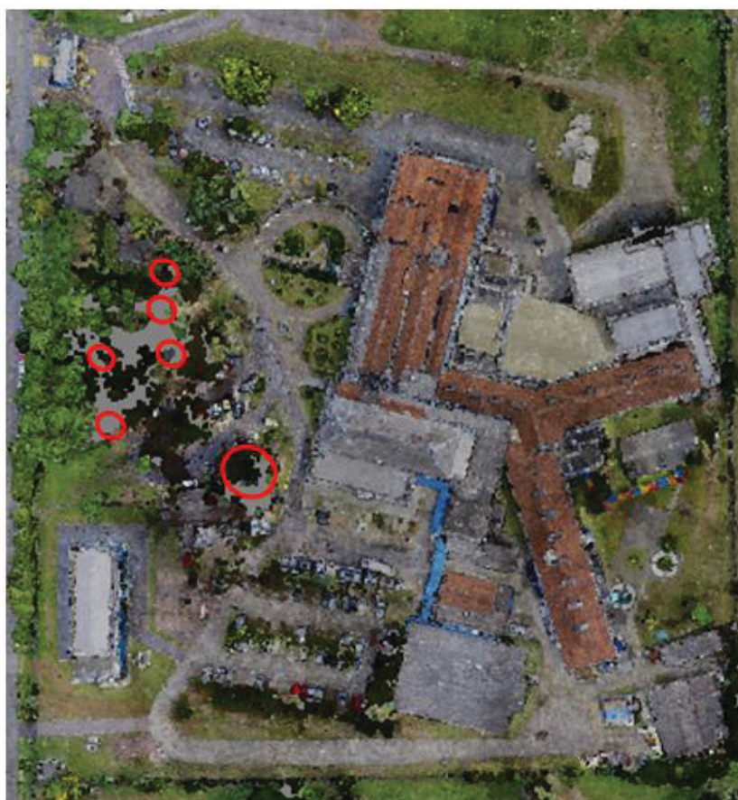
FIGURA 23 – Amostra de cenário para inferência de qualidade visual da nuvem densa de pontos no recobrimento composto a 100 m fotos verticais e inclinadas (RLO 60% e RLA 75%).
