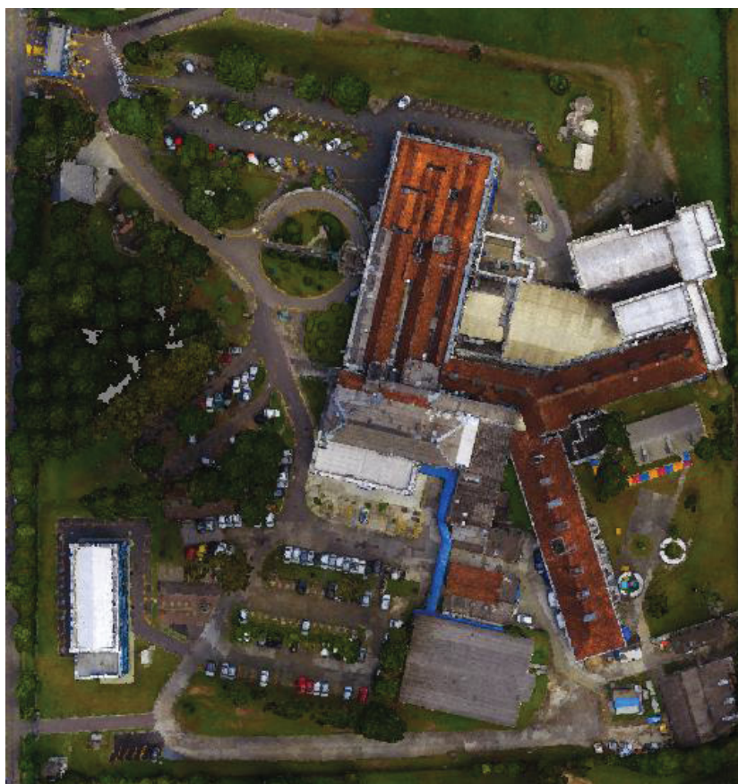
FIGURA 21 – Amostra de cenário para inferência de qualidade visual da nuvem densa de pontos no recobrimento 100 m, Inclinado, faixas cruzadas (RLO 80% e RLA 75%).
