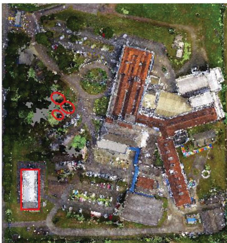
FIGURA 28 – Amostra de cenário para inferência de qualidade visual da nuvem densa de pontos no recobrimento composto a 100 m e 200 m, fotos verticais e inclinadas, (RLO 80% e RLA 75% + RLO 60% e RLA 60%).
