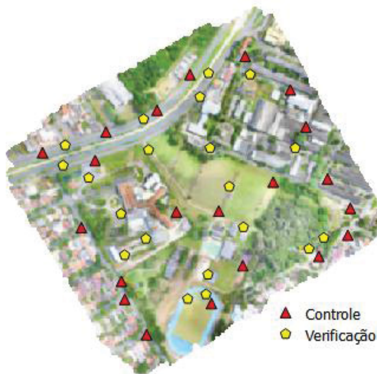
FIGURA 14- Distribuição dos pontos de controle e verificação na Fase 1.
