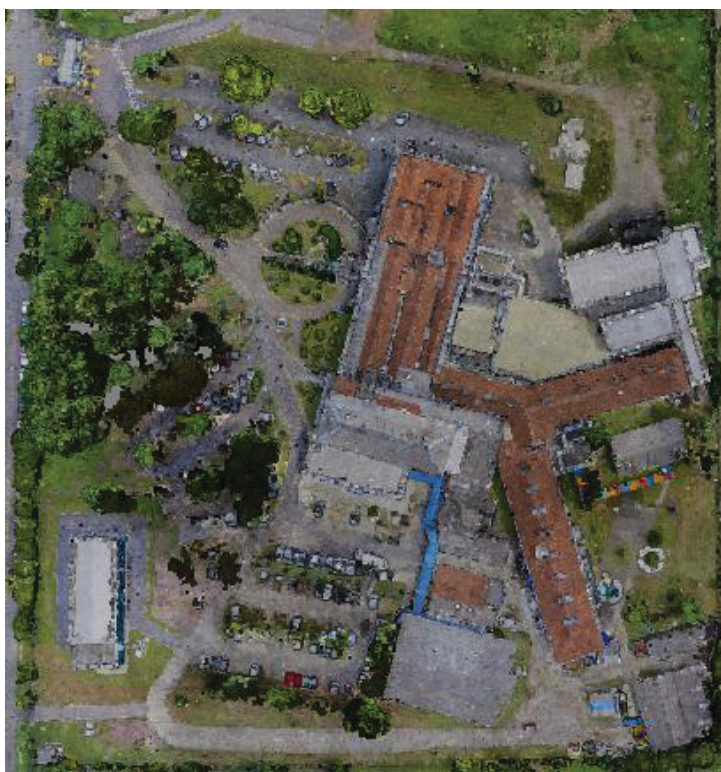
FIGURA 24 – Amostra de cenário para inferência de qualidade visual da nuvem densa de pontos no recobrimento composto a 100 m fotos verticais e inclinadas (RLO 80% e RLA 75%).
