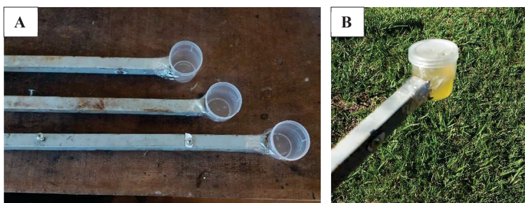
Figura 2. A. Instrumento de coleta, composto por um bastão de metal com coletor urinário acoplado à ponta. B. Amostra de urina coletada.
