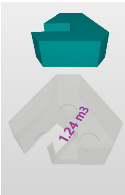
FIGURA 24 - ANÁLISE DOS BLOCOS DE FUNDAÇÃO – BGF
