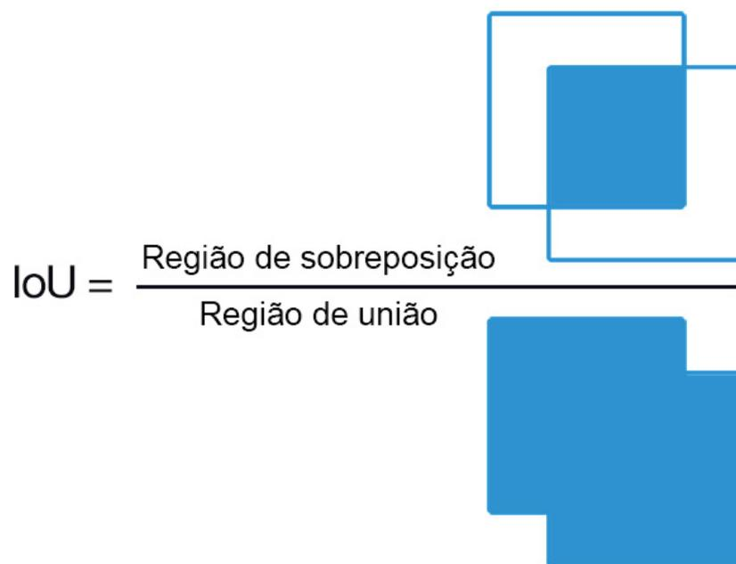
Figura 4.6: O IoU é simplesmente calculado dividindo a área de sobreposição entre *bounding boxes*, pela área de união.
