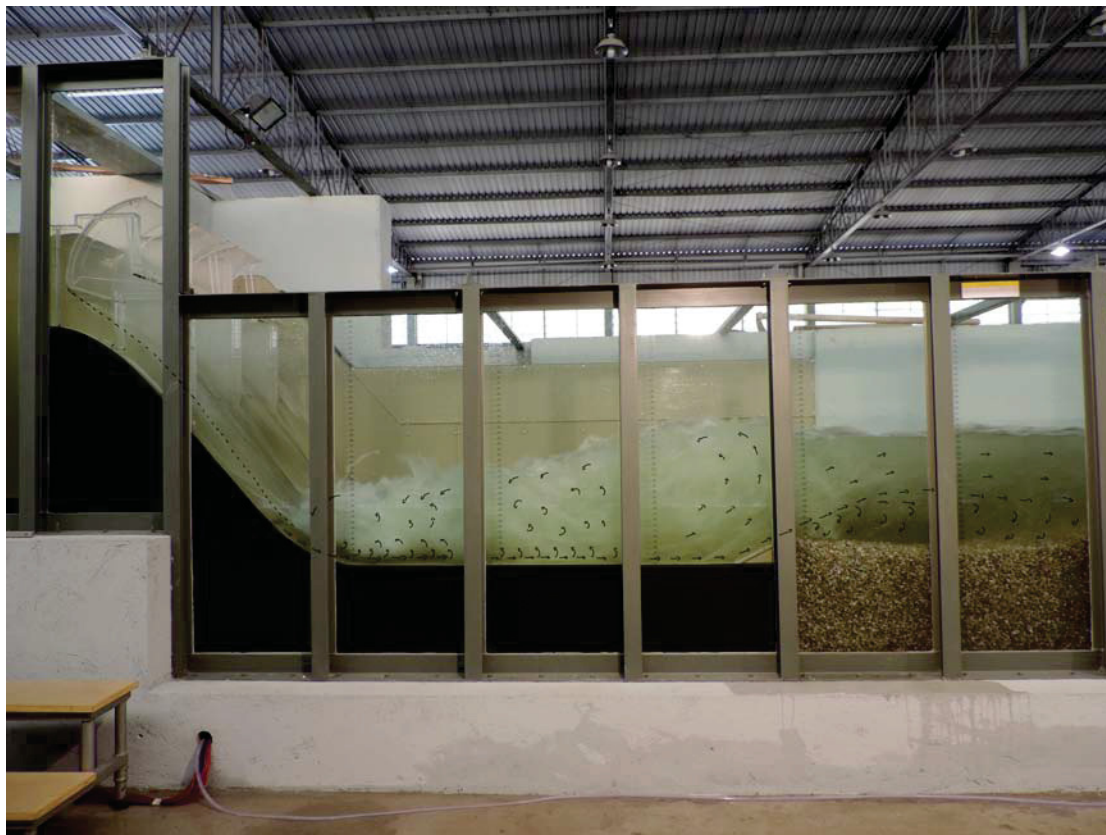
(a) Ensaio 3 - pilares retos
