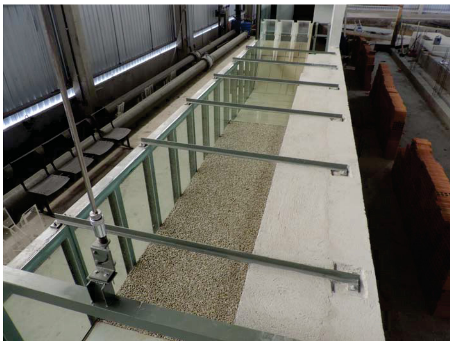
FIGURA 3.7 – MODELO HIDRÁULICO REDUZIDO - FUNDO MÓVEL VISTA DE JUSANTE
