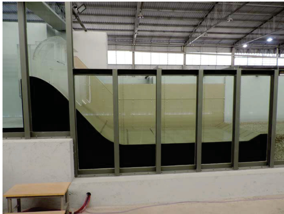
FIGURA 3.5 – MODELO HIDRÁULICO REDUZIDO - VISTA LATERAL DO VERTEDOURO
