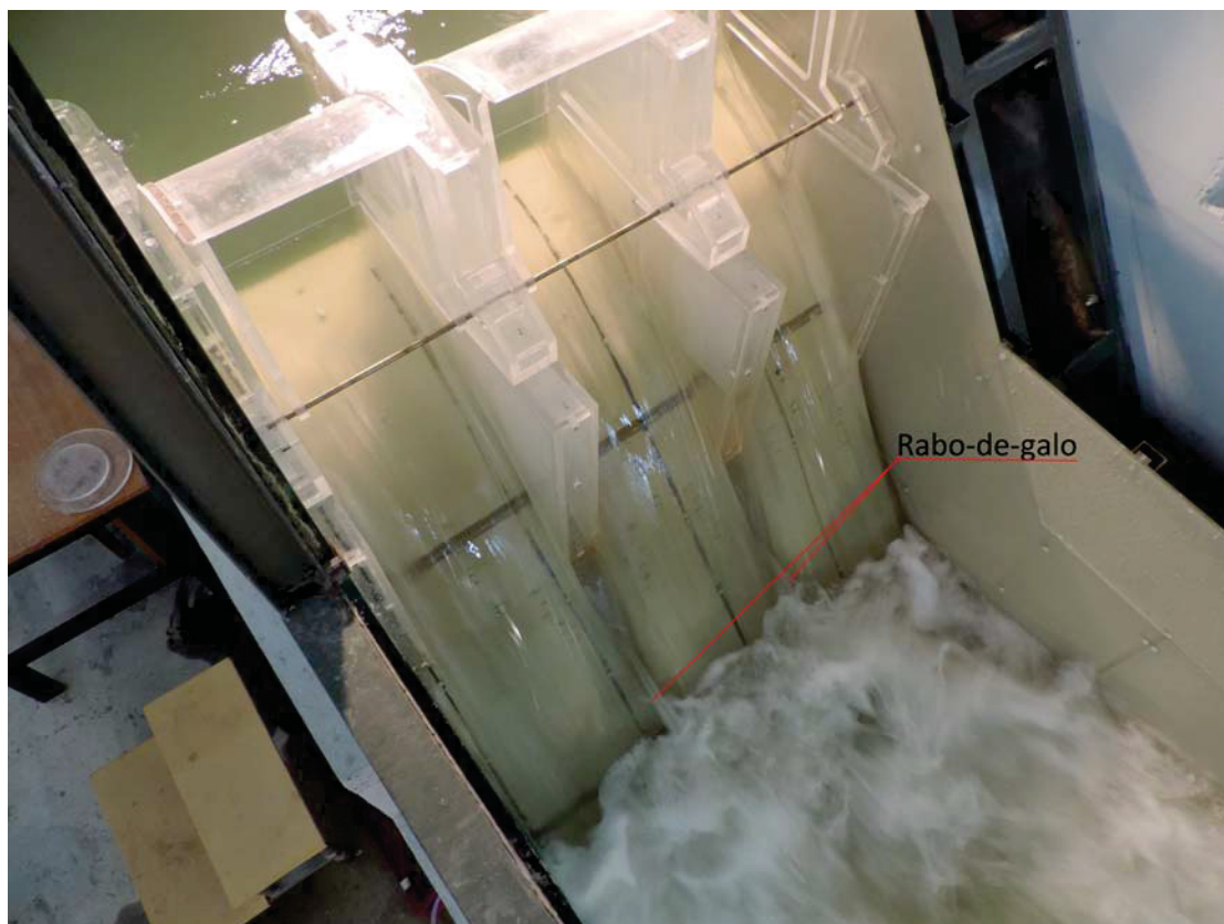
(a) Ensaio com pilares retos
