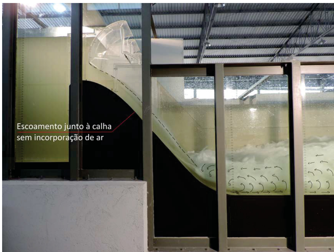
(a) Ensaio com pilares retos
