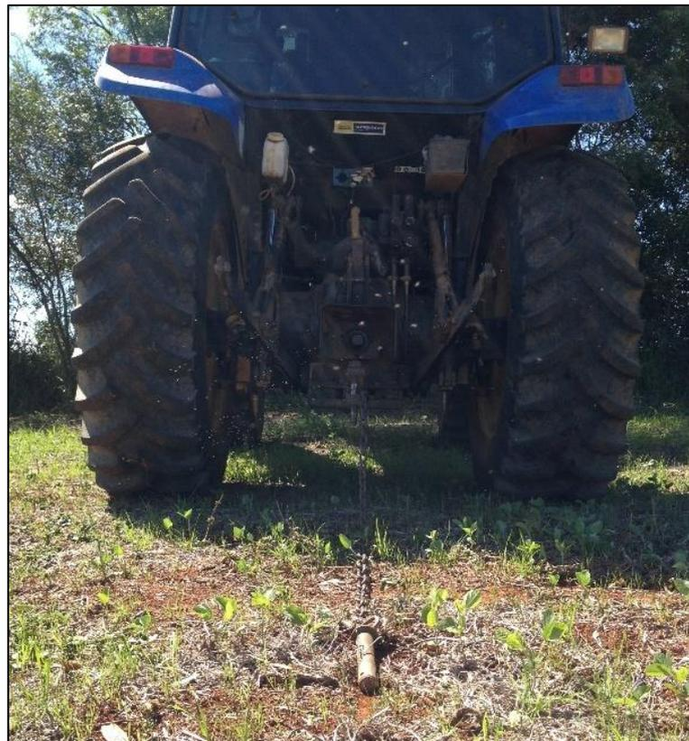
FIGURA 11 – Pino de arraste utilizado para riscar o solo
