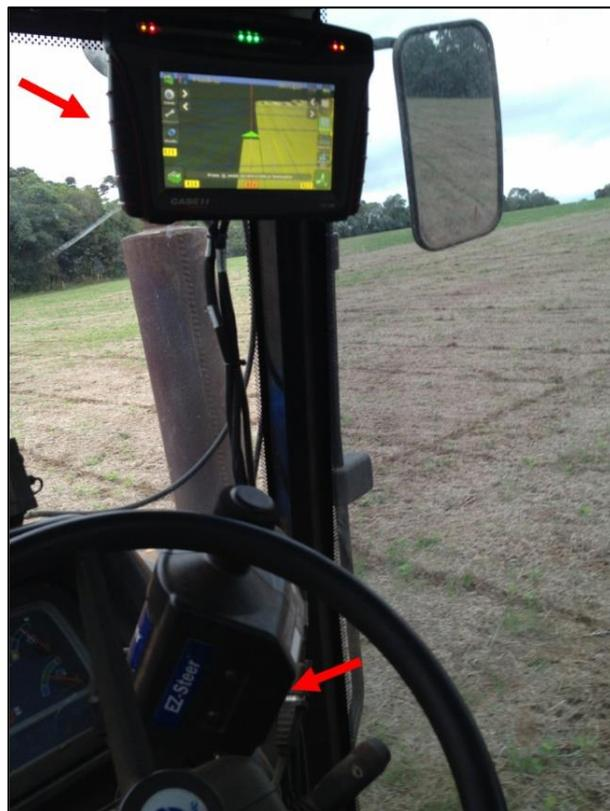
FIGURA 6 – Barra de luz FM750 (acima) e piloto automático elétrico EzSteer (abaixo)
