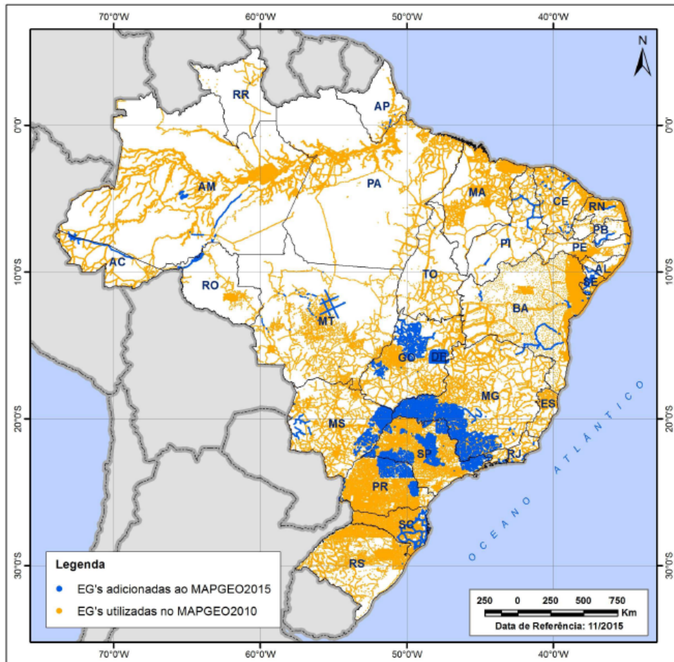
FIGURA 32 – Comparação entre dados gravimétricos utilizados no cálculo do MAPGEO2010 e MAPGEO2015.
