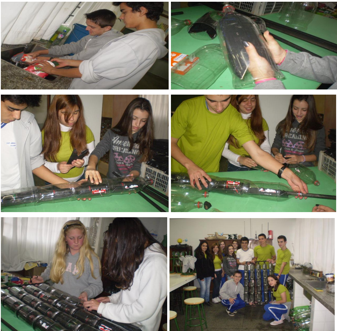
Figura 20-Equipe multidisciplinar na confecção do aquecedor solar.Fotografado por Valdeneia em 20/05/13
