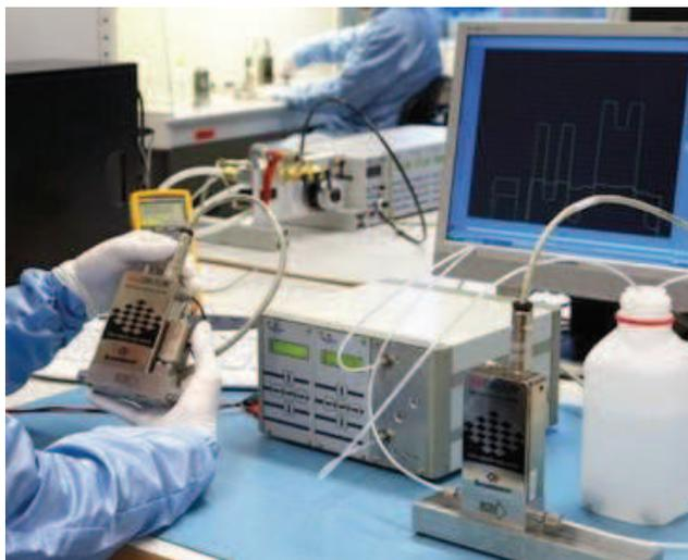
Figura 12 – Imagem de um pesquisador com um SMV micro Coriolis em mãos (Imagem adaptada do site do fabricante [66]).
