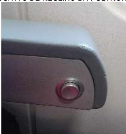
FIGURA 32 - DISPOSITIVO DE RECLINO DA POLTRONA AERONAVE A320
