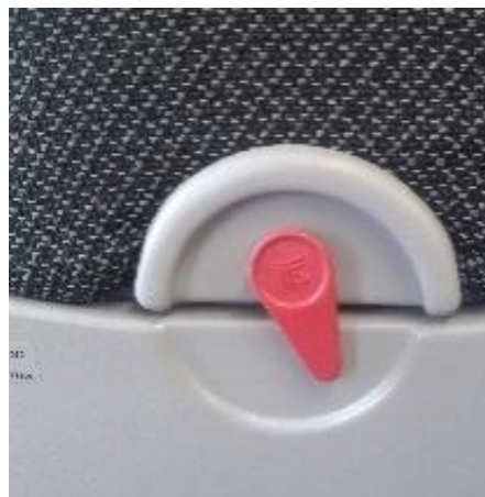
FIGURA 33 - DISPOSITIVO DE TRAVAMENTO DA MESA DE REFEIÇÕES AERONAVE A320
