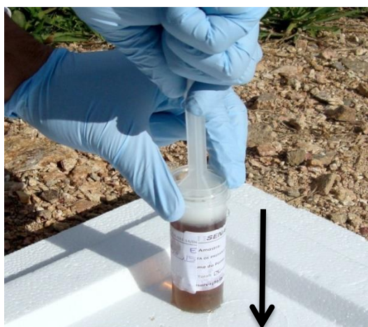
FIGURA 8 - FILTRAÇÃO EM CAMPO.
