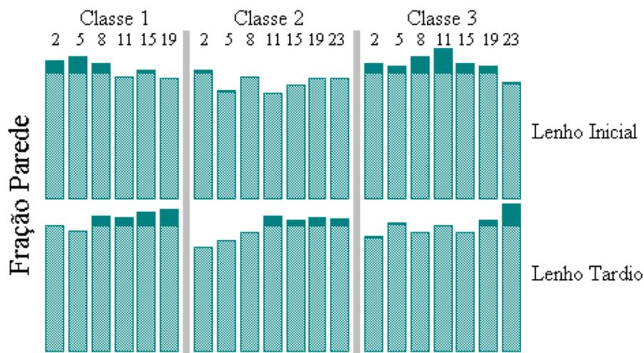
Quanto menor for a Fração Parede, maior será o esticamento, a resistência ao estouro e à tração do papel (WATSON, DADSWELL, 1961, p. 175).
