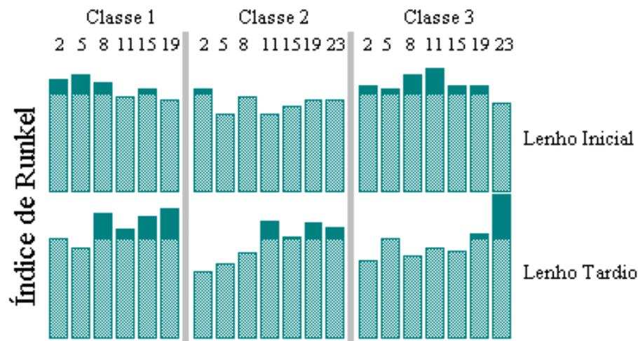
Quanto maior for o Índice de Runkel, menor será a resistência ao arrebentamento e maior será a resistência ao rasgo (WATSON, DADSWELL, 1961, p. 169; FOELKEL, 1976, p. 64).
