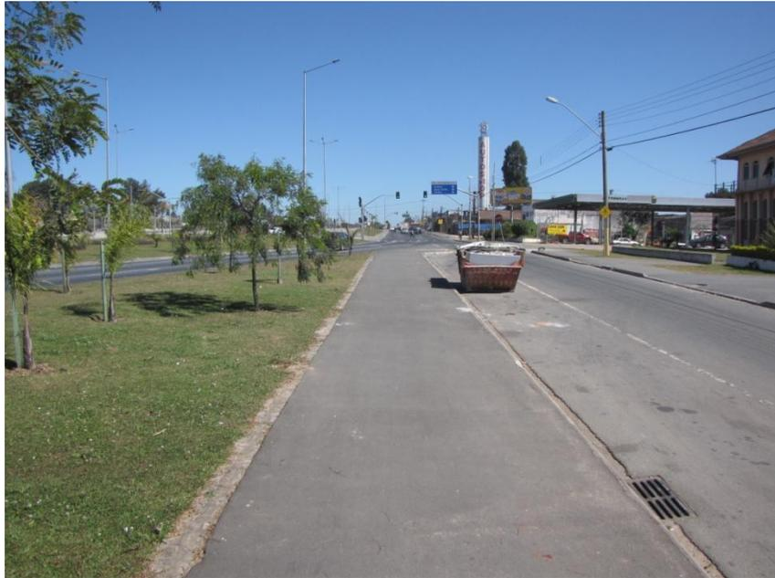
**Foto 01:** Linha Verde Sul em Curitiba – Paraná: Neste trecho falta sinalização de sentido do tráfego, faixas de pedestre e indicação se o espaço é de uso compartilhado ou privativo das bicicletas.
