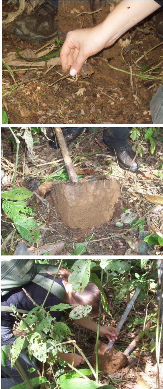
Figura 2. Coleta de solo nas profundidades de 0-5 e 10 cm na Reserva Natural do Rio Cachoeira, Antonina – PR
