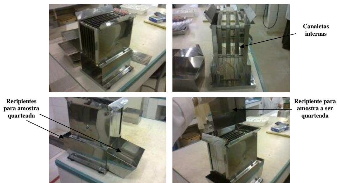
Figura 8 – Quarteador utilizado na preparação das amostras.
