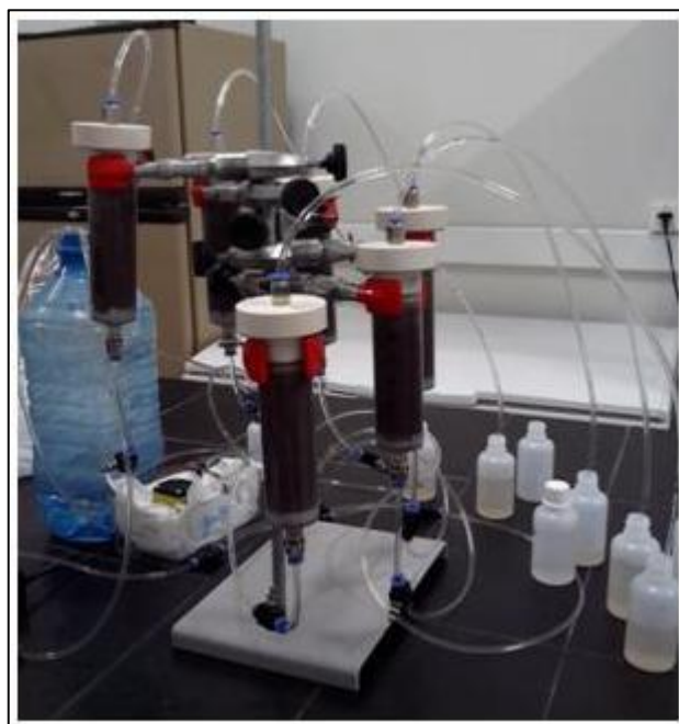
Figura 11 – Experimentos em colunas de lixiviação.
