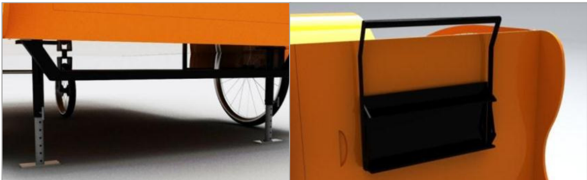
Figura 17, 18- pés de apoio para fixar o carro e propor melhor estabilidade – seguido do amassador de latinhas.
