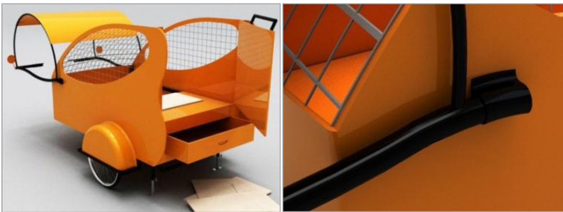
Figura 15, 16 - Gaveteiro para colocar as latinhas amassadas e reforço no guidom.
