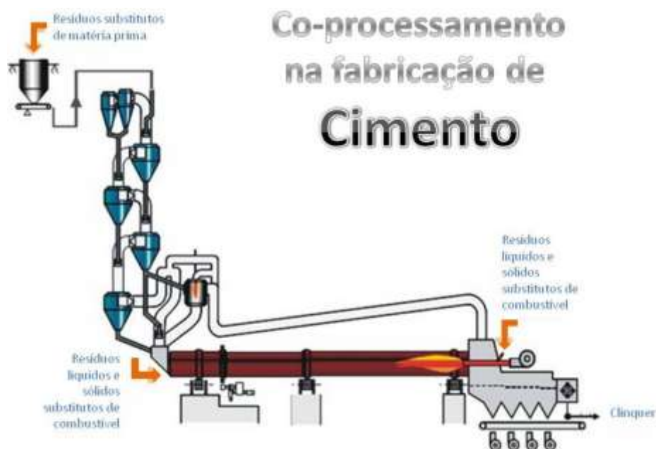
Figura 9: Forno de Clínquer e o Coprocessamento
