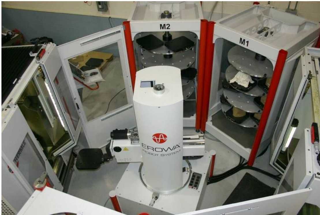
FIGURA 03 - ALIMENTAÇÃO DE CENTROS DE USINAGEM 5 EIXOS COM SISTEMA ROBÓTICO ROTATIVO SINCRONIZADO COM MAGAZINES DE PEÇAS
