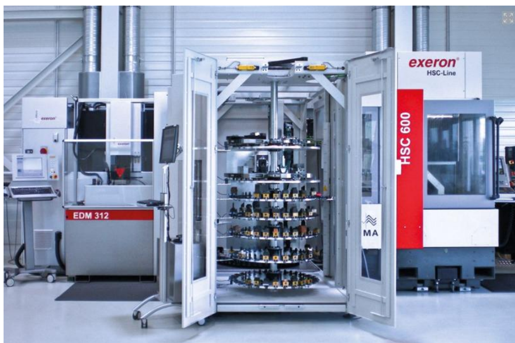
FIGURA 06 - CÉLULA DE MANUFATURA INTEGRA CENTRO DE USINAGEM HIGH-SPEED E ELETROEROSÃO
