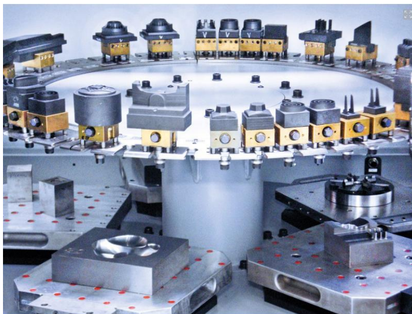
FIGURA 07 - MAGAZINE ROTATIVO COM ELETRODOS E PEÇAS EM PALETES PRESETADOS, TODOS COM SISTEMA DE INDEXAÇÃO TIPO EROWA
