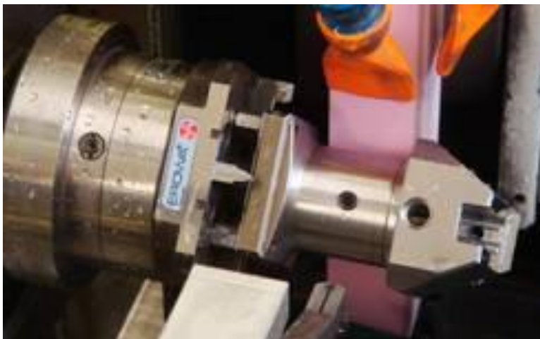
FIGURA 09 - RETÍFICA CILÍNDRICA OPERANDO COM BASE DE INDEXAÇÃO RÁPIDA
