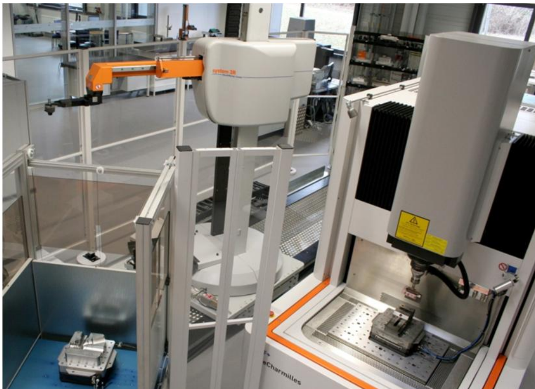
FIGURA 05 - ALIMENTAÇÃO DE PEÇAS E ELETRODOS EM MÁQUINAS DE ELETROEROSÃO COM SISTEMA ROBÓTICO LINEAR SINCRONIZADO COM MAGAZINES
