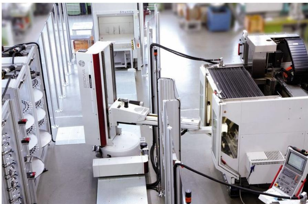
FIGURA 04 - ALIMENTAÇÃO DE CENTROS DE USINAGEM 5 EIXOS COM SISTEMA ROBÓTICO LINEAR SINCRONIZADO COM MAGAZINES DE PEÇAS
