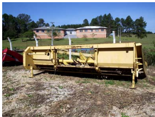
FIGURA 3.A.A - TIPOS DE PLATAFORMAS: COLETA DE GRÃOS E MILHO - COLHEITADEIRA CS 660 – CNH
