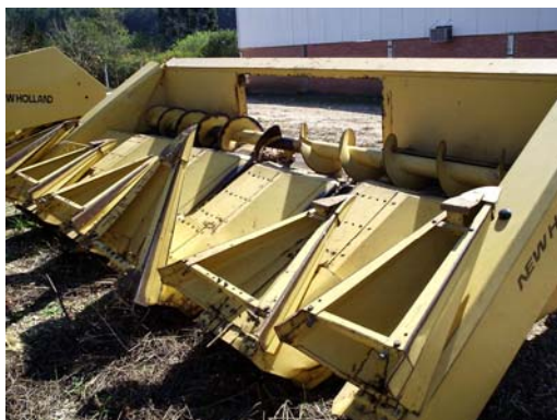
FIGURA 3.A.A - TIPOS DE PLATAFORMAS: COLETA DE GRÃOS E MILHO - COLHEITADEIRA CS 660 – CNH
