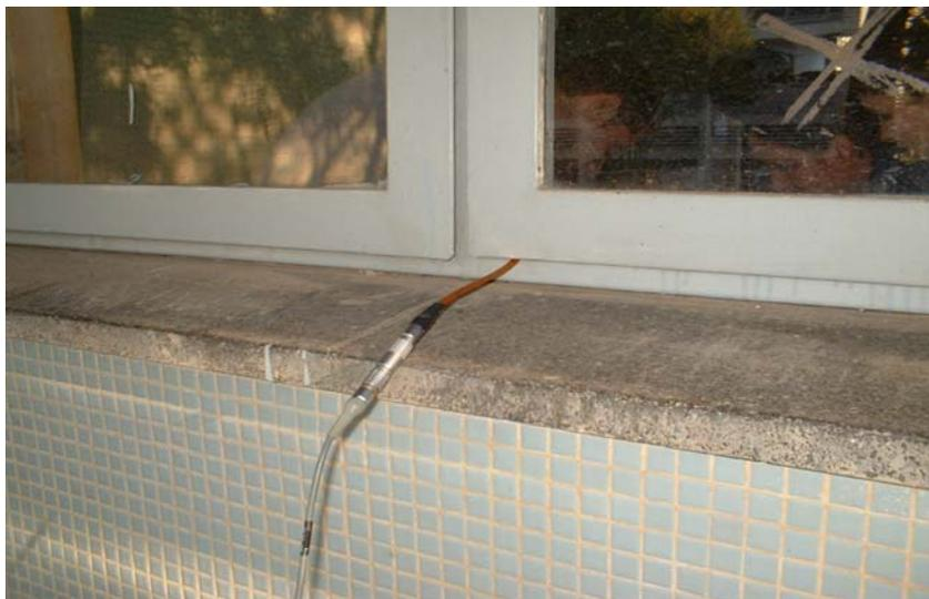
FIGURA 22 – VISTA DO CABO PLANO AR 0014 DO FABRICANTE *BRÜEL & KJAER*
