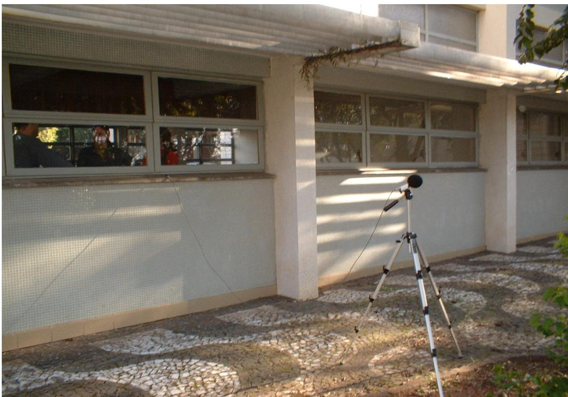
FIGURA 21 – VISTA DO SISTEMA DE MEDIÇÃO DO ISOLAMENTO ACÚSTICO DA FACHADA
