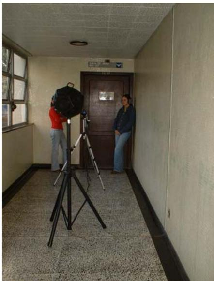
FIGURA 23 – VISTA DO SISTEMA DE MEDIÇÃO DO ÍNDICE DE REDUÇÃO SONORA APARENTE (R') DAS PARTIÇÕES INTERNAS DO BLOCO DIDÁTICO NO CENTRO POLITÉCNICO
