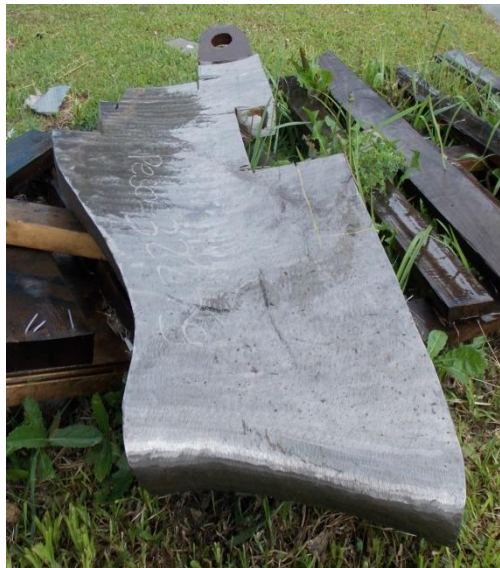
Figura 3.1 Pá da turbina feita de aço CA6NM de onde são retirados os corpos de prova
