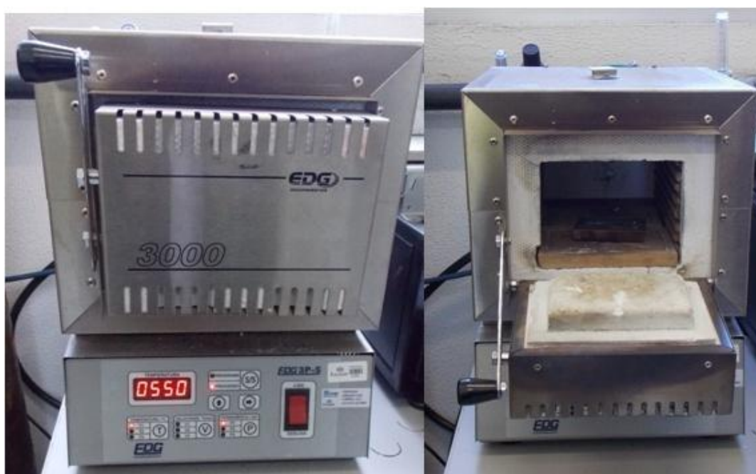
Figura 3.9 - Forno utilizado para o tratamento térmico pós soldagem (TTPS).
