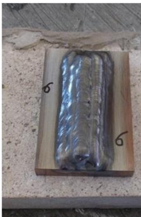
Figura 3.8 - Aspecto final do CP após feitos todos os passes de soldagem
