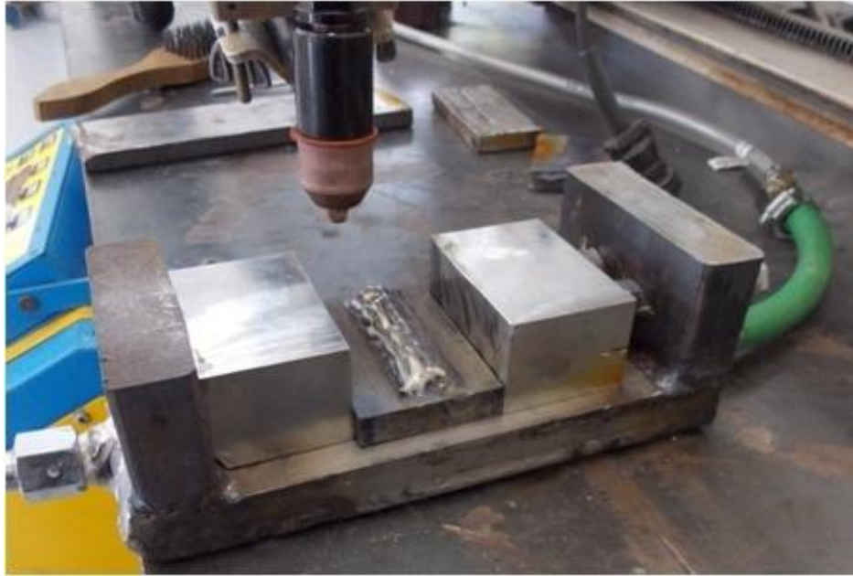
Figura 3.5 - Aspecto final do CP centralizado no dispositivo resfriador
