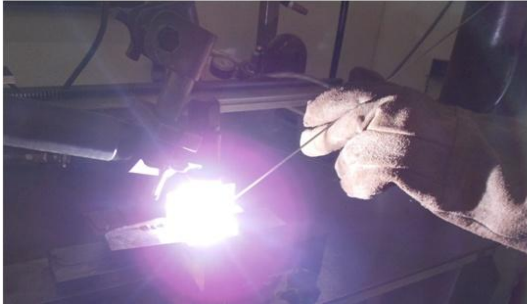
Figura 3.7 - Soldagem plasma PTA mostrando a alimentação com a vareta utilizada para a confecção dos cordões
