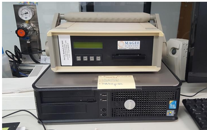
Figura 12 – Transmissômetro óptico Sootscan utilizado para medições de BC nos filtros amostrados.
