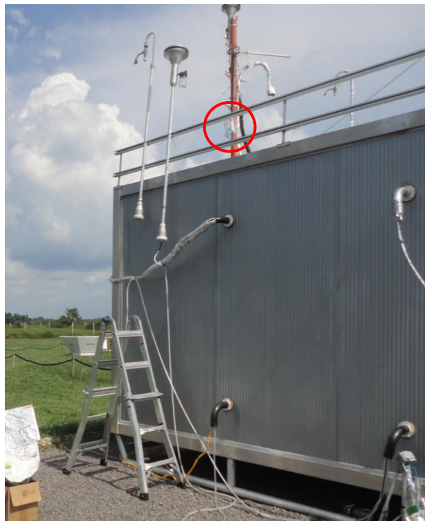
Figura 10 - Localização dos amostradores passivos de gases no ponto T3 03 (indicada pelo círculo vermelho).
