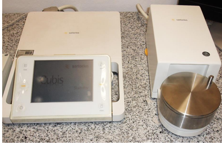
Figura 11 - Microbalanço Sartorius utilizada para a pesagem dos filtros antes e após a amostragem.
