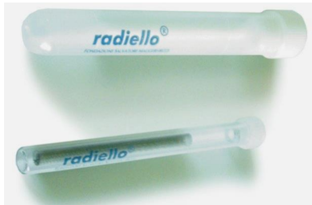
Figura 8 - Cartuchos Adsorventes (o cartucho inferior amostra BTEX; o cartucho superior representa os outros três cartuchos, que possuem aparência análoga).
