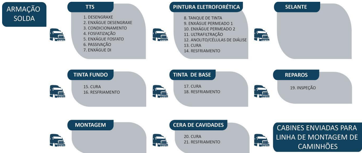
FIGURA 2 - ESQUEMA DO PROCESSO DE PINTURA DE CABINES
