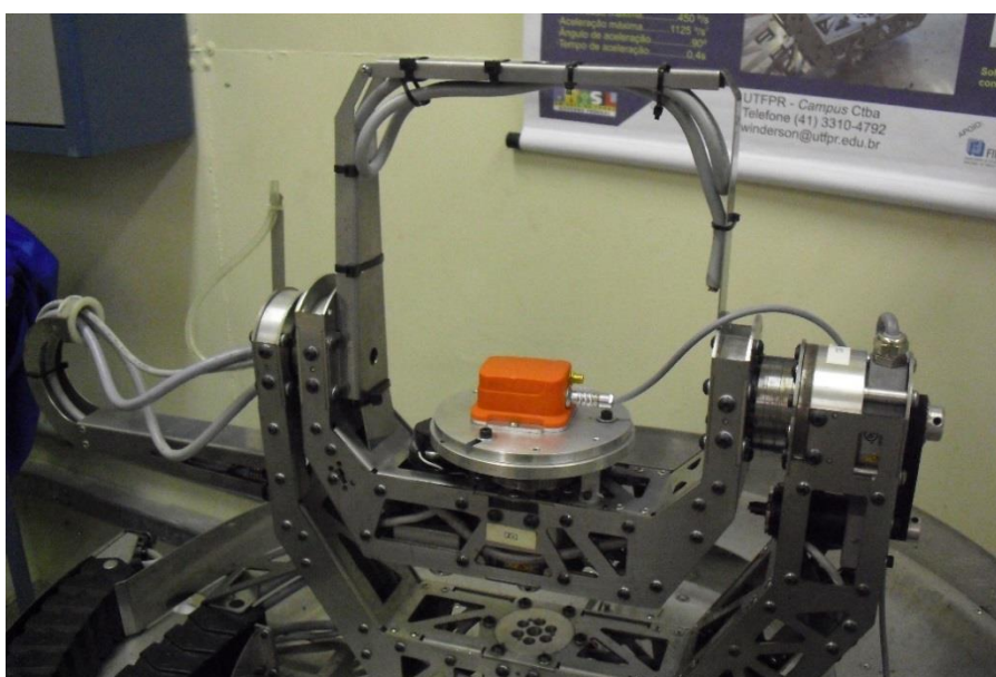
FIGURA 47: COLETA DE DADOS DO SNI MTi-G COM AUXILIO DE UMA BANCADA DE CALIBRAÇÃO FONTE: A AUTORA (2015)
