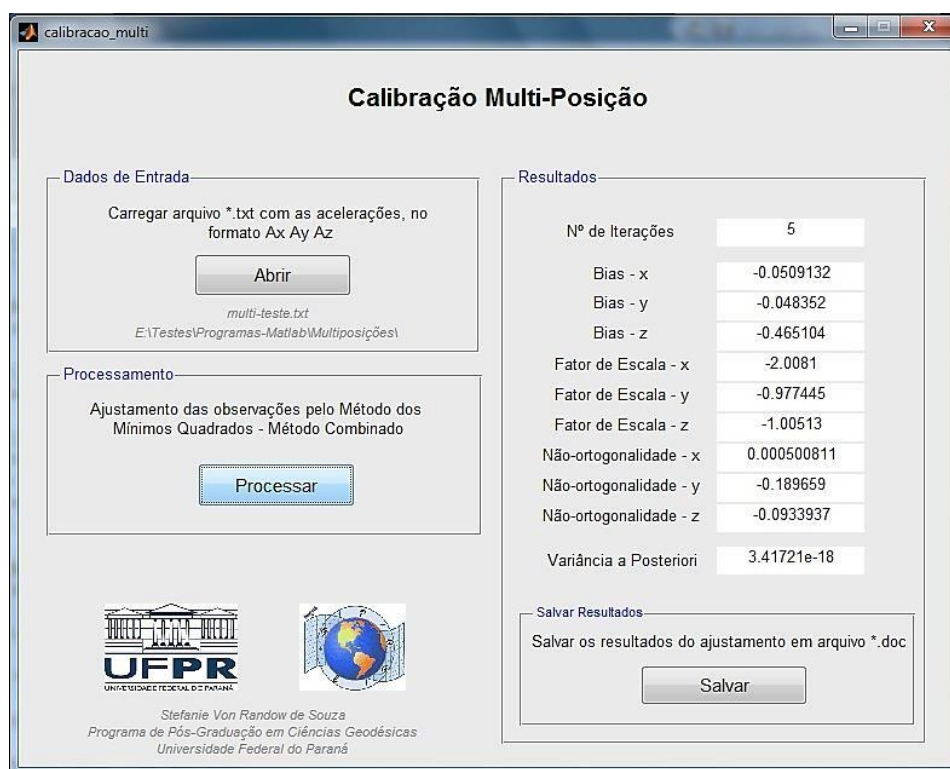
FIGURA 45: ALGORITMO PARA CALIBRAÇÃO MULTI-POSIÇÕES MODIFICADO Fonte: A autora (2015)
