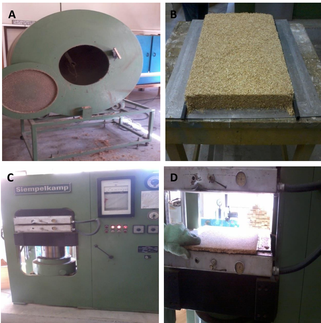
FIGURA 4 – MANUFATURA DOS PAINÉIS DE MADEIRA AGLOMERADA
