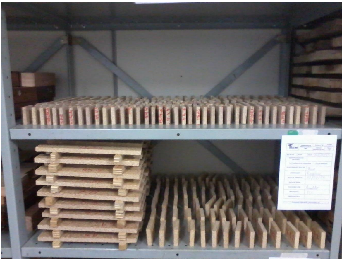
FIGURA 6 – CLIMATIZAÇÃO DOS CORPOS DE PROVA
