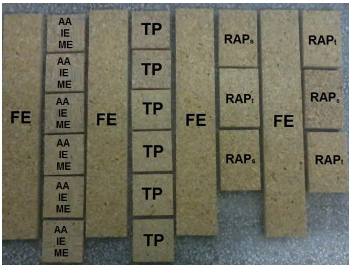
FIGURA 5 – ESQUEMA DE CORTE DOS CORPOS DE PROVA
