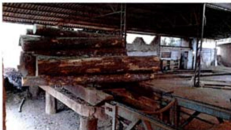
FIGURA 7 - ESTEIRA TRANSPORTADORA DE TORAS COM CORRENTE FONTE: O AUTOR (2014)
