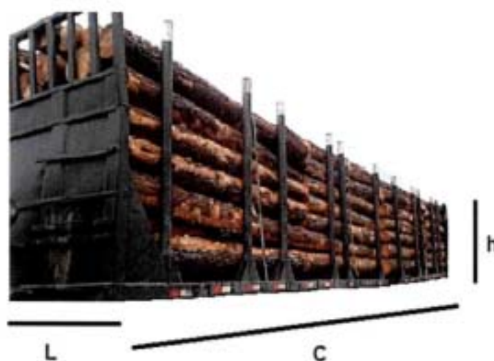
FIGURA 5 - MEDIÇÃO DAS DIMENSÕES E VOLUME DE UMA CARGA DE TORAS FONTE: O AUTOR(2014)
