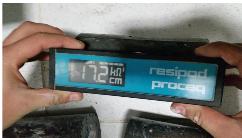
FIGURA 37 – ENSAIO DE RESISTIVIDADE ELÉTRICA
