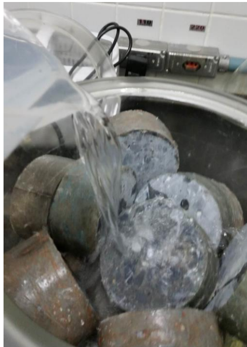
FIGURA 23 – INCREMENTO DE ÁGUA DESTILADA AO DESSECADOR PARA O ENSAIO DE MIGRAÇÃO DE ÍONS CLORETO
