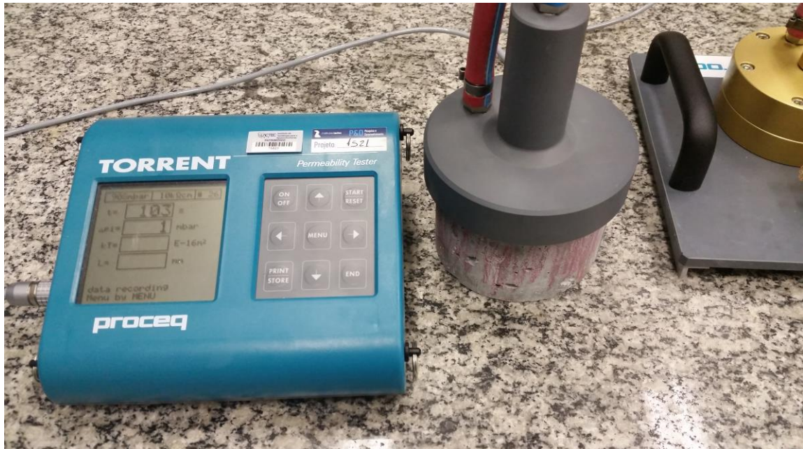
FIGURA 35 – MEDIÇÃO DE K_T (COEFICIENTE DE PERMEABILIDADE DO CONCRETO) ENSAIO DE PERMEABILIDADE AO AR
