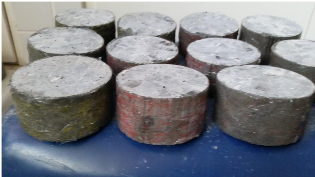
FIGURA 20 – AMOSTRAS SELADAS COM SILICONE PARA O ENSAIO DE MIGRAÇÃO DE ÍONS CLORETO
