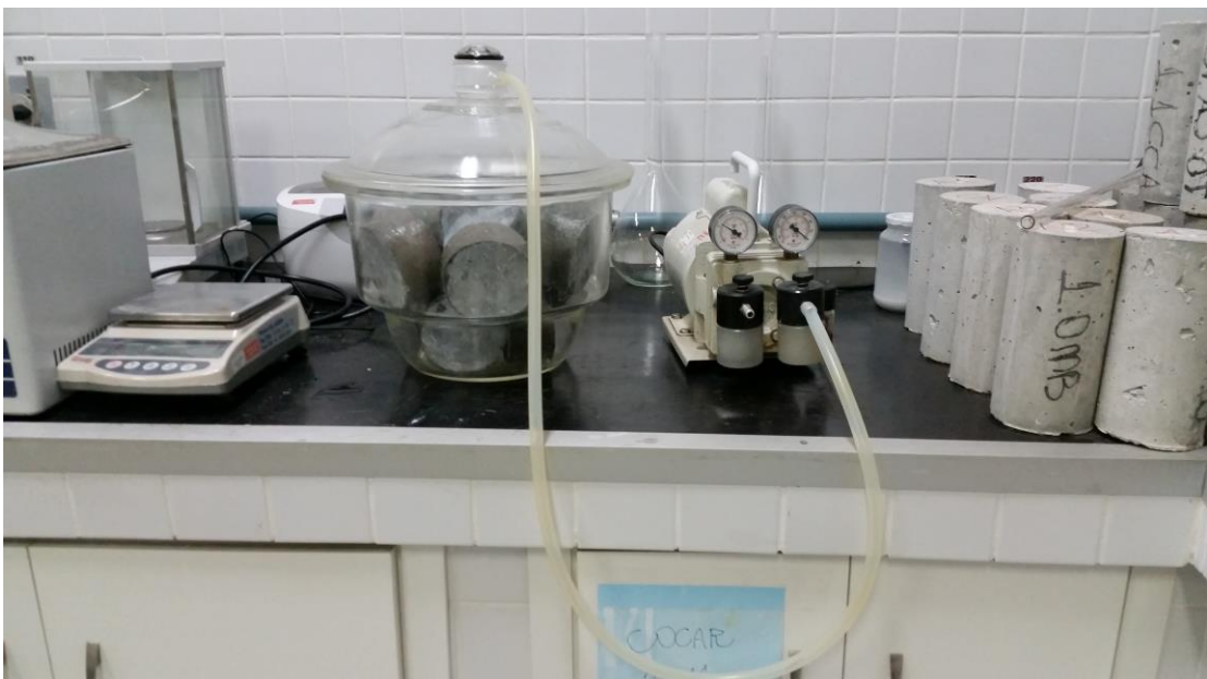
FIGURA 22 – CORPOS DE PROVA APENAS À VACULO POR 3 HORAS PARA O ENSAIO DE MIGRAÇÃO DE ÍONS CLORETO
