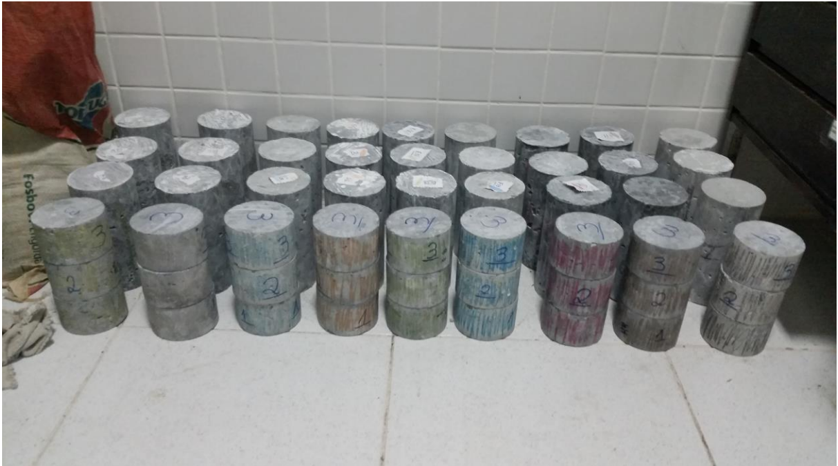
FIGURA 32 – CAPEAMENTO E CORTE DOS CORPOS DE PROVA PARA ENSAIO DE PERMEABILIDADE
