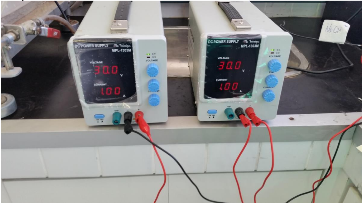
FIGURA 29 – APLICAÇÃO DE CARGA PASSANTE DE 60V NA REALIZAÇÃO DO ENSAIO DE MIGRAÇÃO DE ÍONS CLORETO
