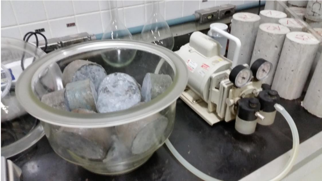
FIGURA 21 – CORPOS DE PROVA ENCAMINHADOS AO DESSECADOR PARA O ENSAIO DE MIGRAÇÃO DE ÍONS CLORETO
