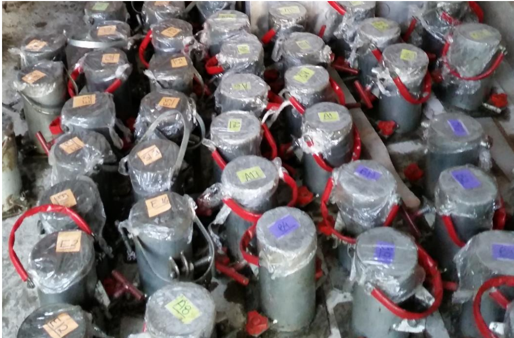
FIGURA 13 - CORPOS DE PROVA DE CONCRETO APÓS MOLDAGEM
