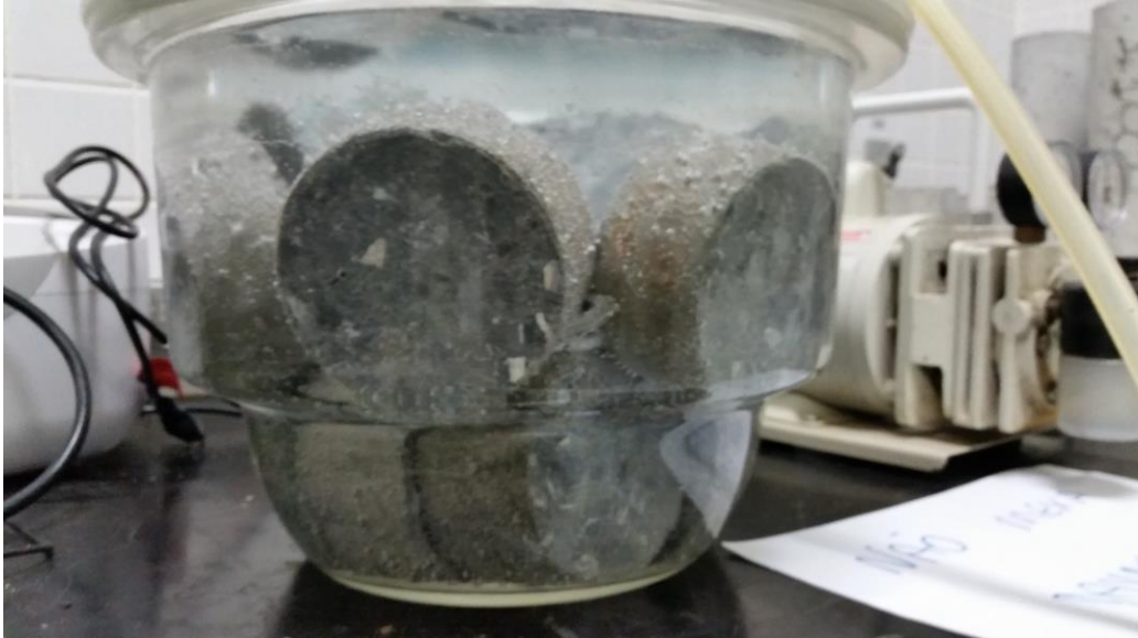
FIGURA 25 – APLICAÇÃO DE VÁCUO COM ÁGUA DESTILADA E IMERSÃO DAS AMOSTRAS PARA O ENSAIO DE MIGRAÇÃO DE ÍONS CLORETO
