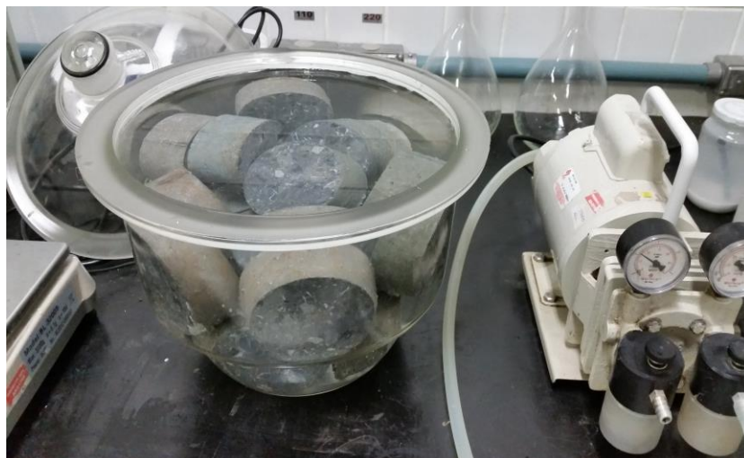
FIGURA 24 – CORPOS DE PROVA SUBMERSOS AO DESSECADOR PARA O ENSAIO DE MIGRAÇÃO DE ÍONS CLORETO
