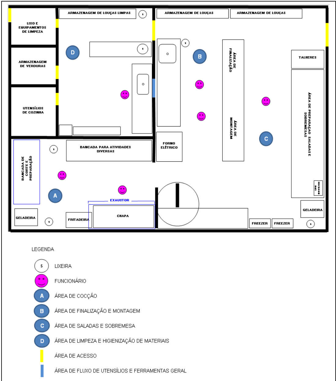
Figura 6 - Leiaute da cozinha Industrial antes da reestruturação.
