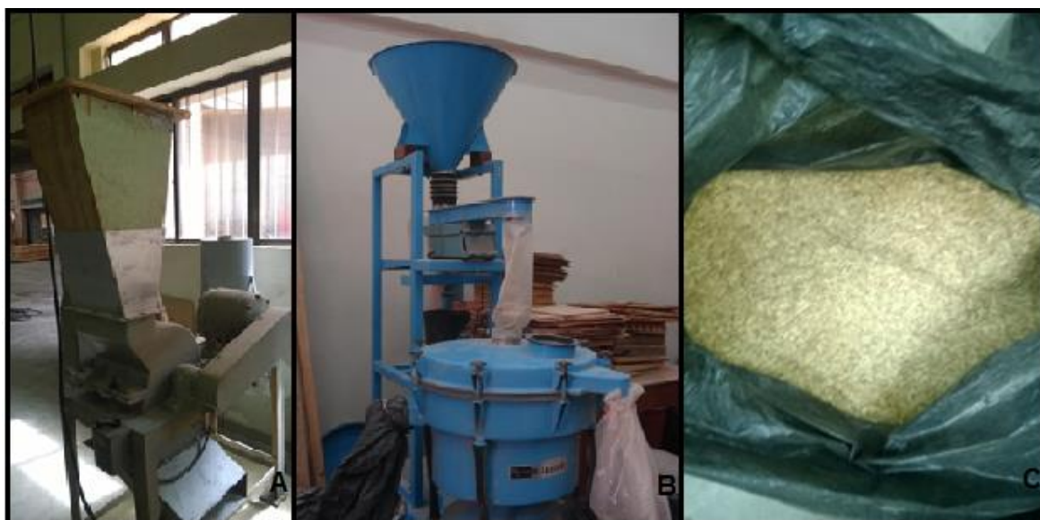
FIGURA 6 - MOAGEM E CLASSIFICAÇÃO DAS PARTÍCULAS. a) Moinho martelo; b) Classificador; c) Partículas sliver classificadas.
