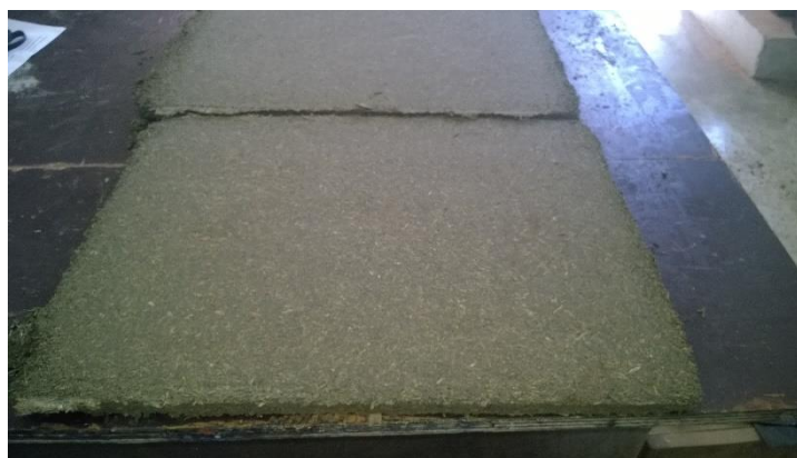
FIGURA 14- PAINÉIS CIMENTO MADEIRA APÓS A PRENSAGEM. FONTE: O autor.
