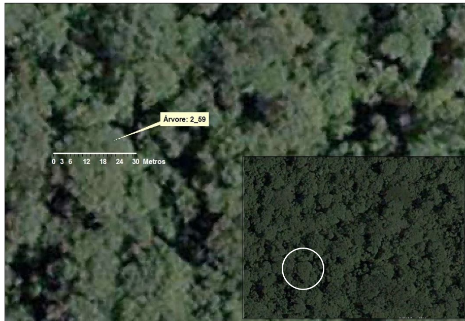
FIGURA 4 – DETERMINAÇÃO DO DIÂMETRO DE COPA COM USO DE SIG FONTE: Google Earth (2012)
