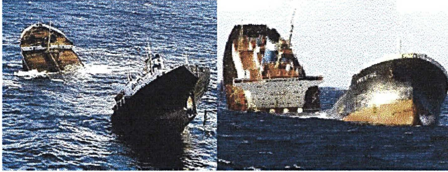
Figura 1.1 Fratura catastrófica ocorrida em 20/11/2002 no petroleiro Prestige , que levava 77 mil toneladas de óleo combustível e afundou cerca de 250 km da costa noroeste da Espanha [7].
