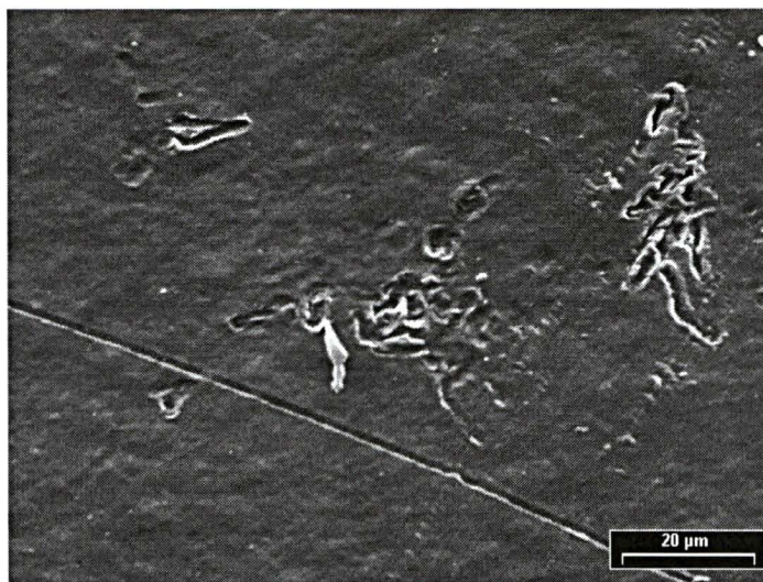
Figura 6.7 - Imagem de um filme original. É um detalhe da imagem anterior onde são evidenciadas as imperfeições no filme (Distância de trabalho 14,8 mm e tensão de aceleração de 15kV).
