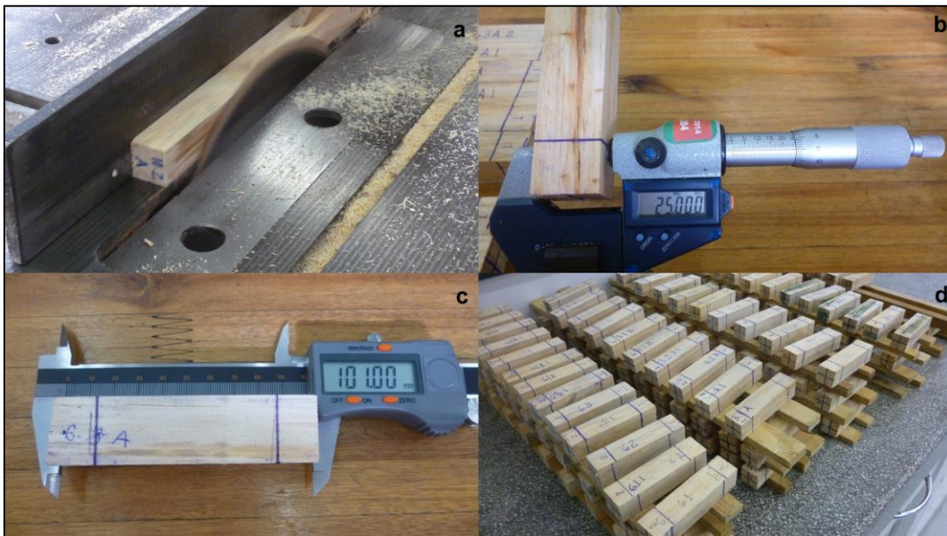
FIGURA 7: PREPARAÇÃO DOS CORPOS DE PROVA E ETAPAS PARA DETERMINAÇÃO DA ESTABILIDADE DIMENSIONAL
