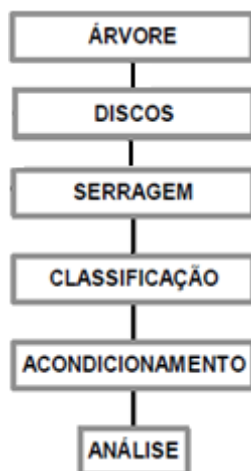
FIGURA 10: Esquema das etapas de preparação da madeira para análises químicas.
