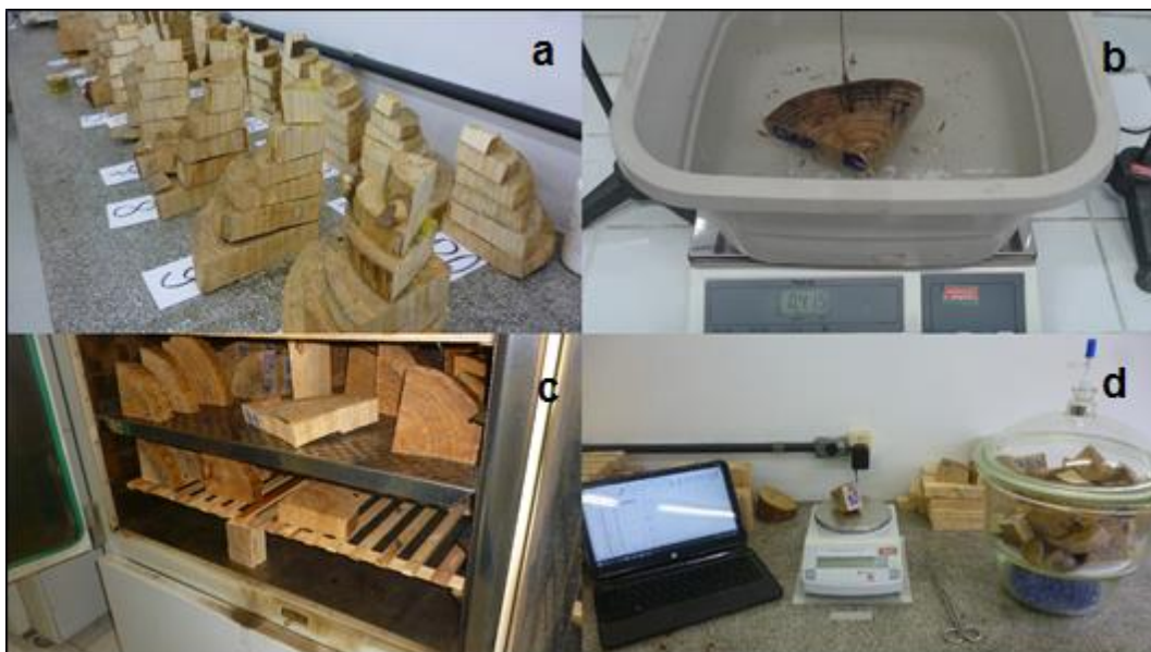
FIGURA 6: ETAPAS PARA DETERMINAÇÃO DA MASSA ESPECÍFICA BÁSICA.
