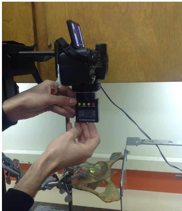
FIGURA 6 – VERIFICAÇÃO DO POSICIONAMENTO HORIZONTAL DA LENTE DA CÂMERA FOTOGRÁFICA COM INCLINÔMETRO DIGITAL.
