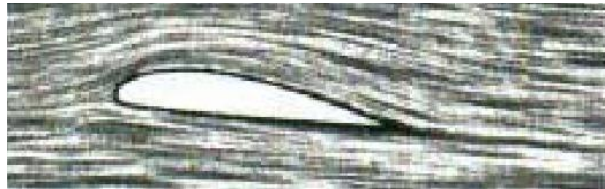
Figura 99 – Fluxo de ar aderente à pá Fonte: Custódio (2009)
