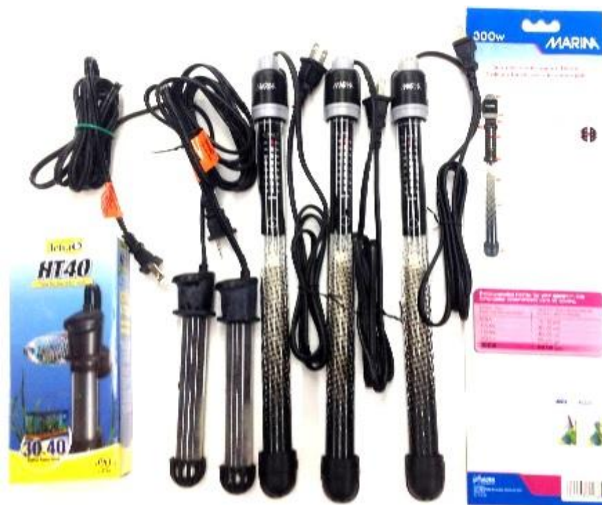
FIGURA 4 - SISTEMAS DE AQUECIMENTO UTILIZADOS NO INTERIOR DO TANQUE EXTERNO DO SISTEMA PILOTO DE REFRIGERAÇÃO POR COMPRESSÃO DE VAPOR DESENVOLVIDO. FONTE: A AUTORA (2014)
