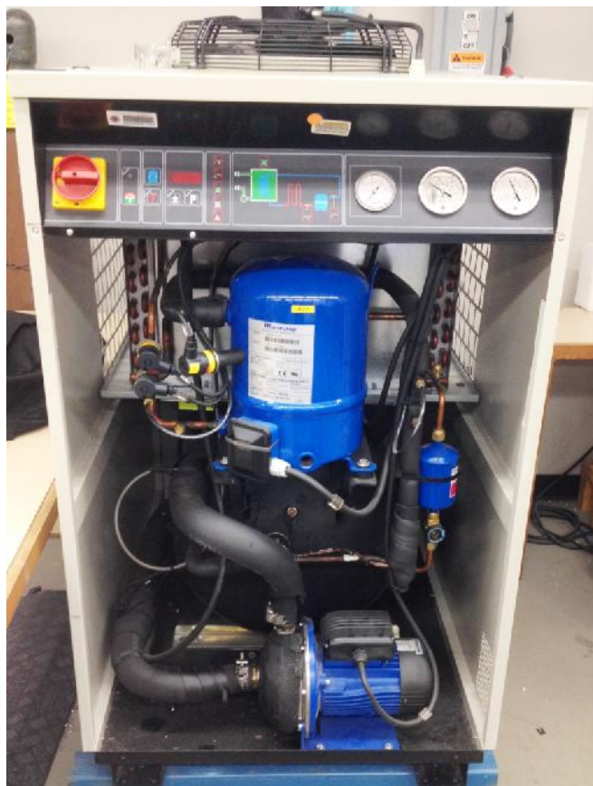
FIGURA 3 - CHILLER UTILIZADO NO SISTEMA PILOTO DE REFRIGERAÇÃO, PARA OBTENÇÃO DE DADOS EXPERIMENTAIS. FONTE: A AUTORA (2014)
