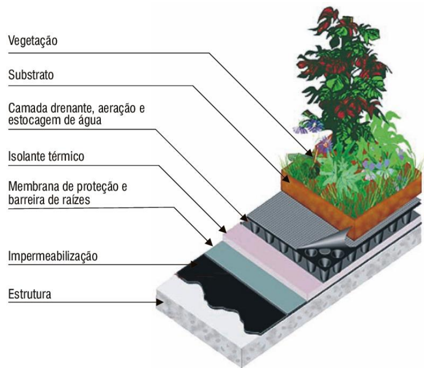
FIGURA 9: ESQUEMA DAS MULTICAMADAS DE COBERTURA VERDE
