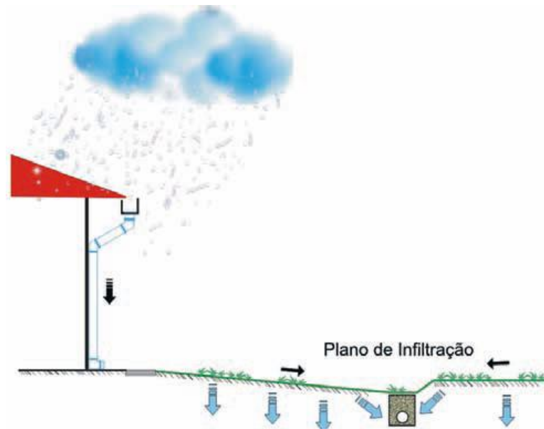
FIGURA 5: PLANO DE INFILTRAÇÃO COM DEPRESSÃO E DRENO PARA INFILTRAÇÃO FONTE: METROPOLITAN COUNCIL; BARR ENGINEERING CO (2004).
