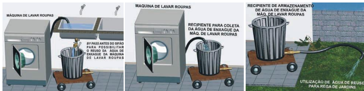
FIGURA 11: ESQUEMA DE UTILIZAÇÃO DE ÁGUA DE MÁQUINA DE LAVAR PARA IRRIGAÇÃO DE JARDIM
