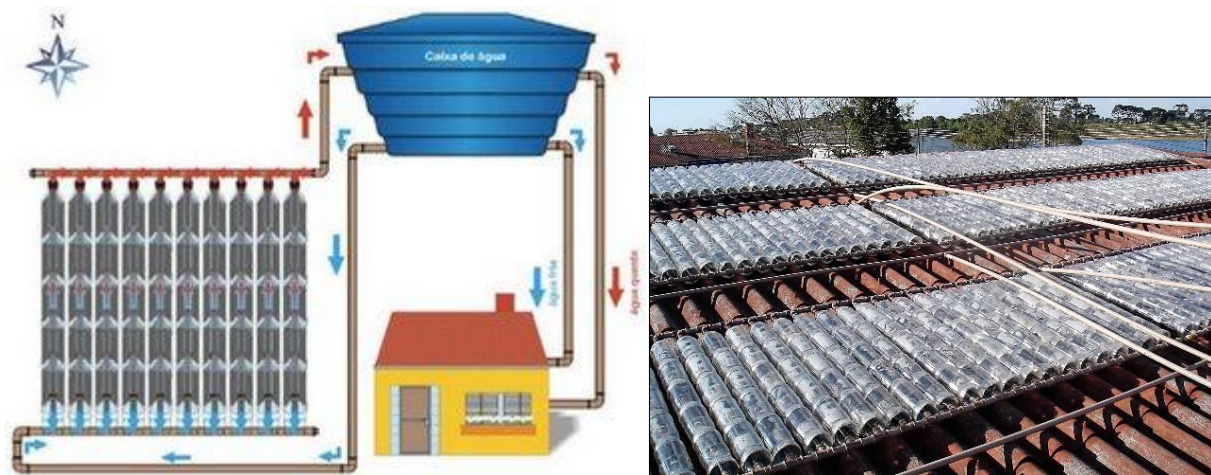
FIGURA 29: AQUECEDOR SOLAR FEITO DE MATERIAL RECICLADO FONTE: http://www.infoescola.com/ecologia/aquecedor-solar-de-material-reciclado
