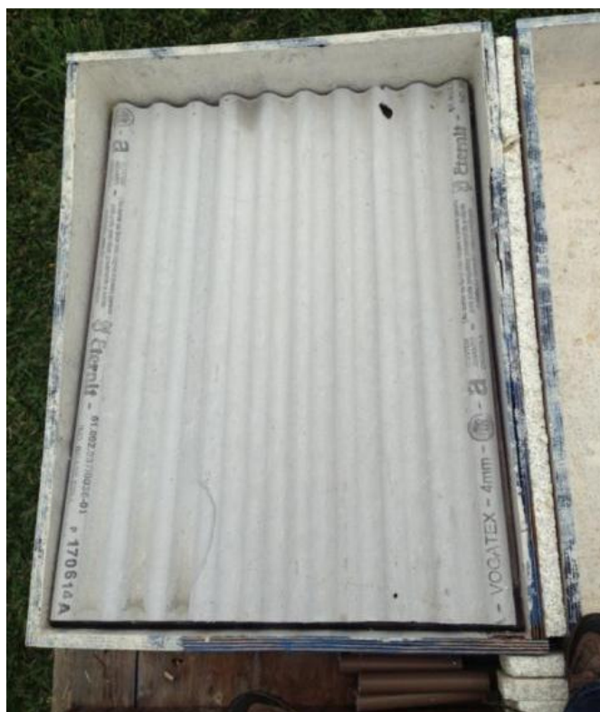
figura 75 - Módulo com cobertura de telha de fibrocimento Fonte: A Autora (2014)
