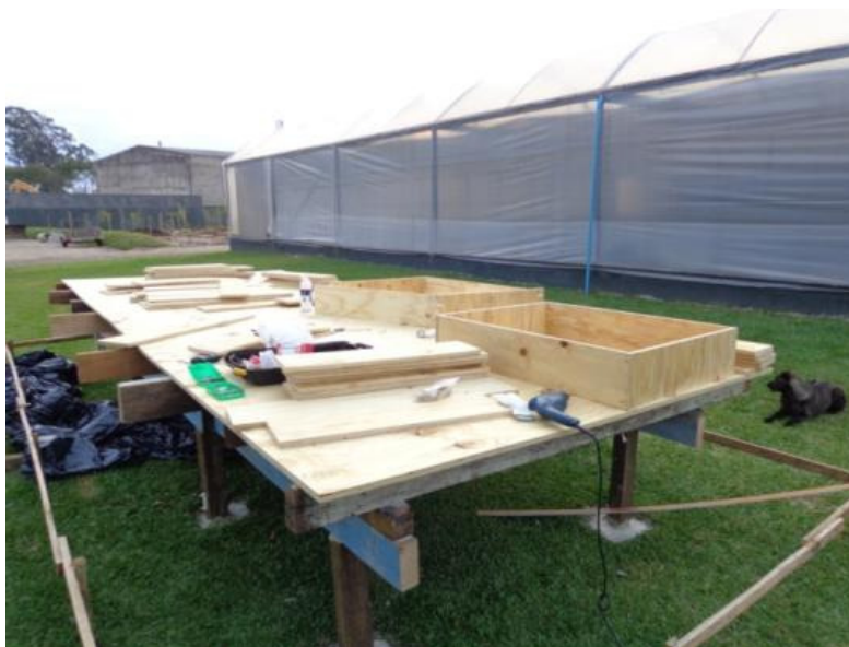
figura 32 - Mesa de teste de telhados, demonstrado a inclinação prevista para os módulos Fonte: A Autora (2013)
