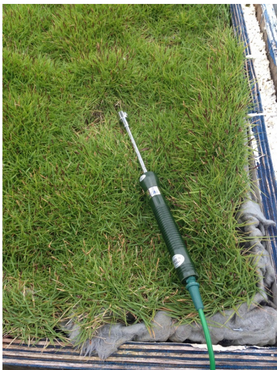
figura 82 - sensor instalado para medição superficial superior Fonte: A autora (2015)
