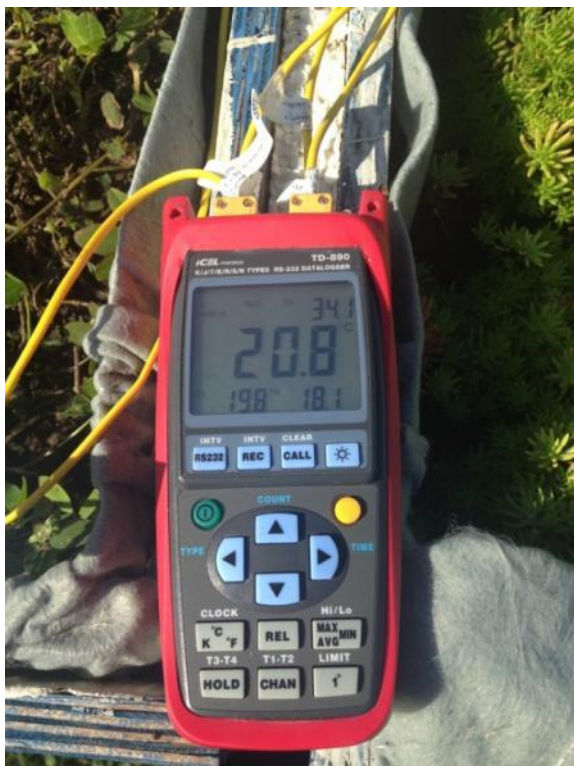
figura 79 - Datalogger TD-90 com termopares do tipo K Fonte: A autora (2014)
