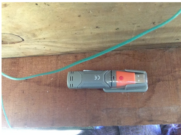
figura 84 - HT-4000 fixado na estrutura de madeira Fonte: A Autora (2015)
