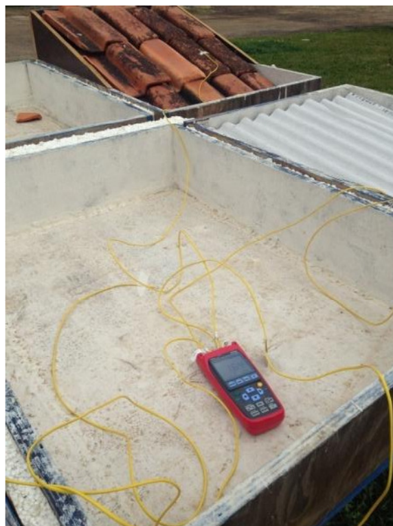
figura 80 - medição com datalogger TD-890 e termopares do tipo K Fonte: A autora (2014)
