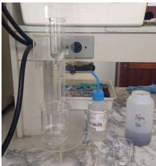
figura 95 - Redução pela coluna Cd-Cu Fonte: A autora (2014)
