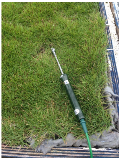
figura 105 - Sensor tipo K temperatura superficial superior.
