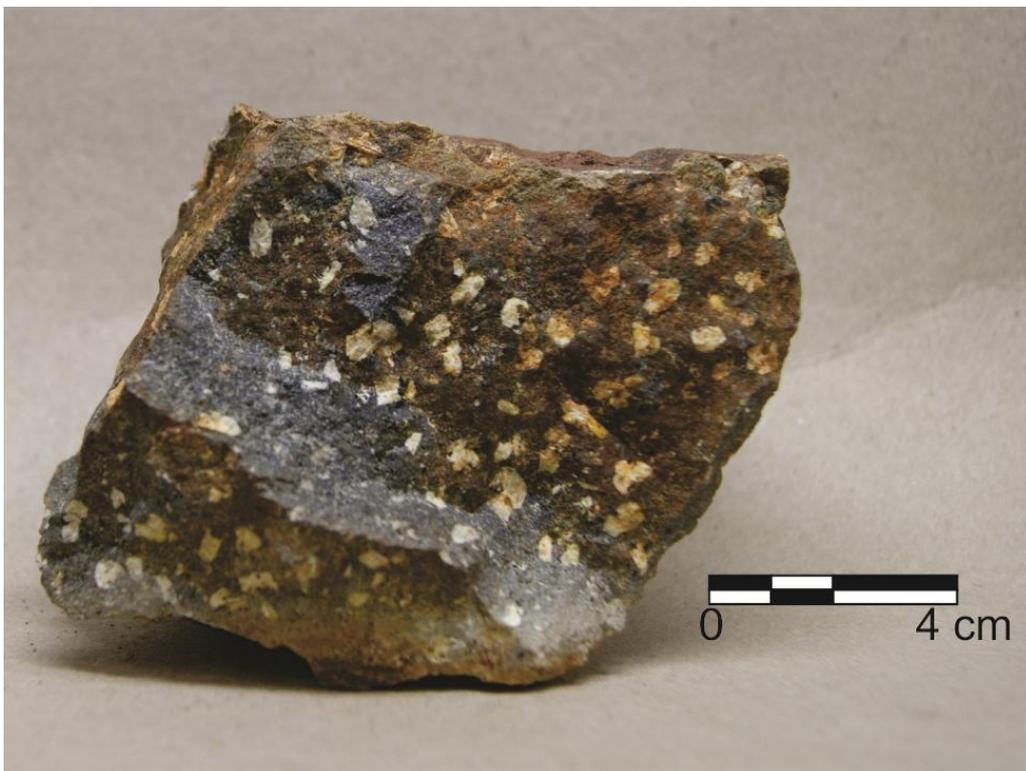
Figura 5.28: Amostra do dacito pórfiro, com fenocristais de plagioclásio esbranquiçados e superfície amarelada por alteração.
