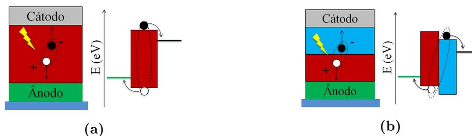
**Figura 4.2:** (a) Sistema monocamada e (b) Sistema de heterojunção de bicamada (a parte em vermelho representa o polímero fotosensível e a parte em azul o aceitador de elétrons. Ao lado de cada figura temos a representação dos níveis de energia do sistema e o éxciton.
